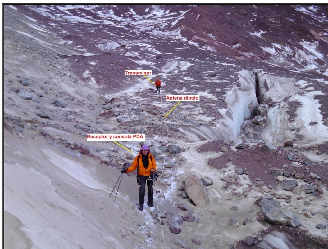
**Figura A.1-A. Levantamiento con radar para hielo en el glaciar Aparejo, junio 2015. En rojo, y con fondo blanco, se indican los elementos básicos para la operación del radar; antena dipolo, transmisor y receptor. El receptor GPS se ubica hacia el frente de la imagen, transportado por el autor.**
