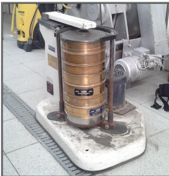
**Figura 3.3.1-A. Tamizadora Ro-Tap Rx-29-10 utilizada para el análisis de granulometría.**
