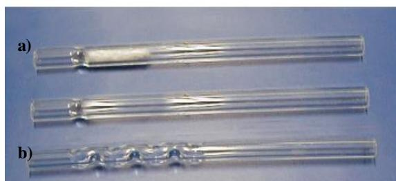
Figura 10. Liner para puertos de inyección PTV de un cromatógrafo gaseoso, a) Liner PTV con lana de vidrio y b) Liner PTV deflex.
