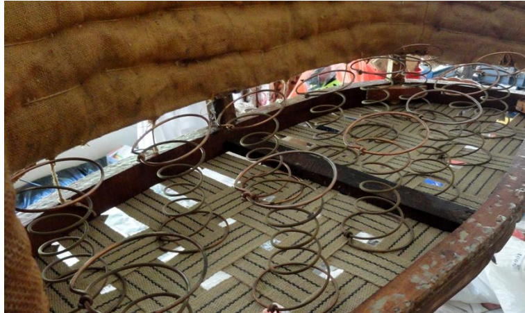
Ilustración 104: Colocación de resortes distribuidos homogéneamente.
