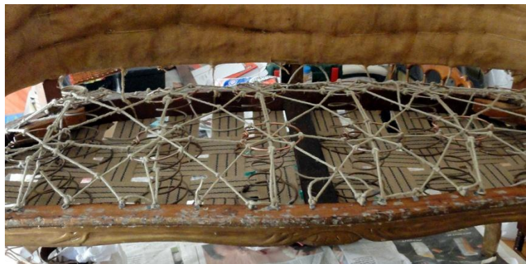
Ilustración 105: Anudando los resortes con cordeles verticales
