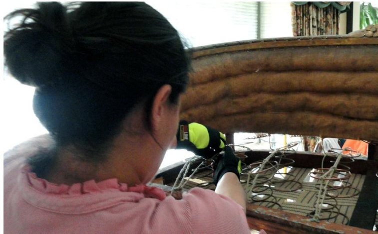
Ilustración 105: Anudando los resortes con cordeles verticales
