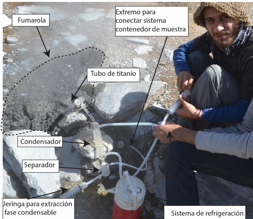
Figura 3.2. Muestreo de fumarola, mostrando los elementos usados.
