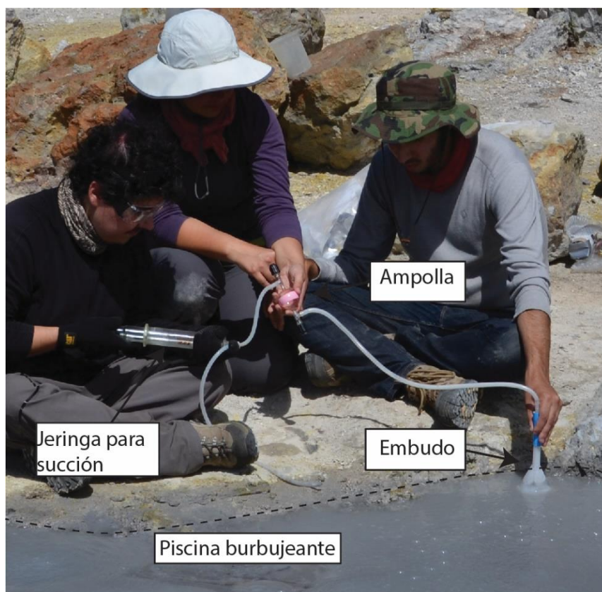
Figura 3.3. Muestreo en piscina burbujeante mostrando los elementos usados
