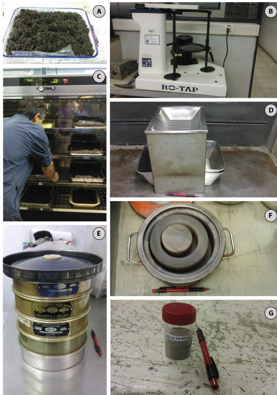
Figura 2.3. Resumen de la preparación de muestras que se lleva a cabo en el Taller de Molienda del Sernageomin. A) Muestra húmeda es distribuida en las bandejas, C) Horno utilizado para el secado de muestras a una temperatura de 25°C a 30 °C, E) Torre de tamices, B) Tamizadora ROTAP, que funciona mediante movimientos circulares horizontales y un golpeteo vertical, D) Cuarteador de muestras, utilizado para dividir la muestra de manera representativa, F) Olla de Anillos de ágata que forman parte del Molino Pulverizador Rocklabs donde el material es pulverizado, y se obtiene la granulometría requerida para los análisis G) resultado final, donde 40 gr del material obtenido por cada muestra se almacenan en frascos estériles y se rotulan.
