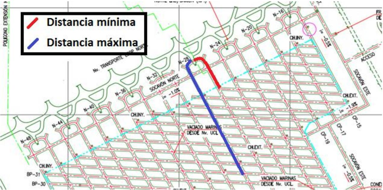
Ilustración 22 Distancias máxima y mínima ciclo LHD, III Panel Extendido (Edición de imagen presentada en Mengoya et al., 2015)
