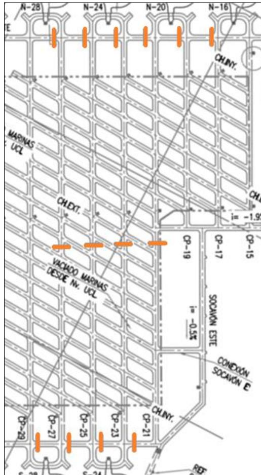
Ilustración 24 Confinamiento sector calles de producción LHD (Edición de imagen presentada en Mengoya et al., 2015)
