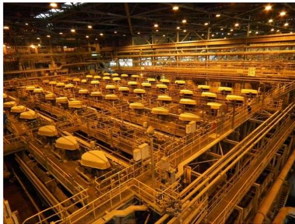
Figura 7. Bancos de celdas de flotación en una faena ubicada en Chile (Outotec, 2011).
