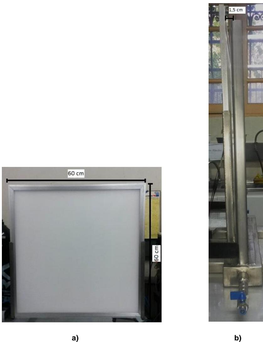
Figura 34. Luz LED implementada en el sistema. a) Dimensiones de la luz. b) Separación entre la luz LED y la celda.
