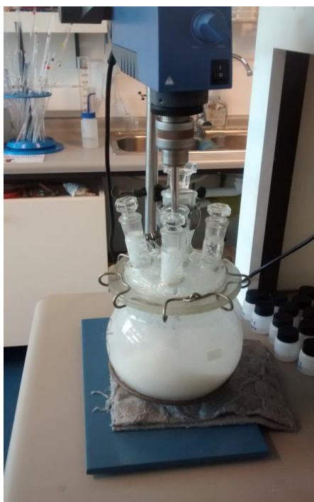
Figura 2: Reactor empleado en la síntesis de silicatos de calcio modificados con Mg
