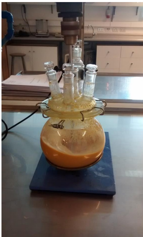
Figura 3: Reactor empleado en la síntesis de silicato de calcio modificado con Fe
