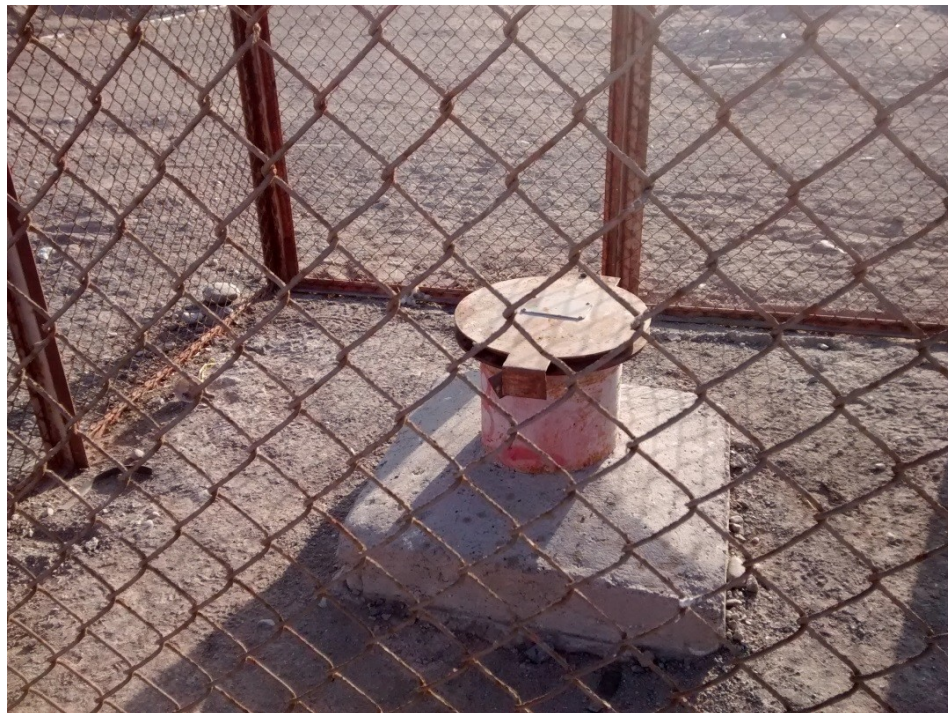
Figura 4.5.3-3 Pozo de control DGA
