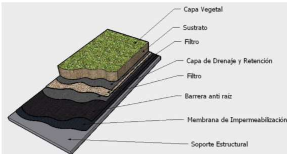
Figura 17: Capas básicas de una cubierta vegetal. Fuente CTD año 2013
