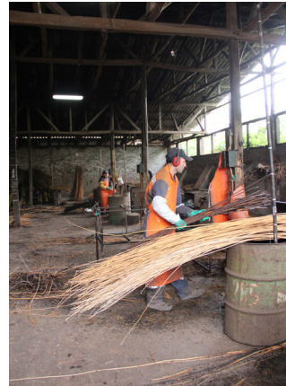
Proceso de descortezamiento eléctrico, Mimbre cocido.
