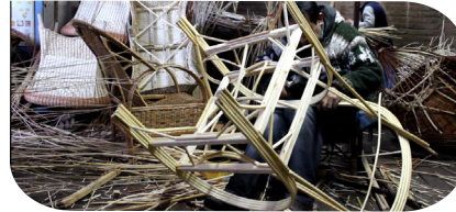
Imágenes X Construcción arco superior respaldo Elaboración propia.
