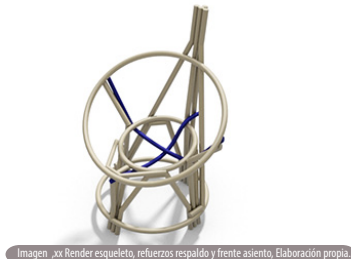
Imagen .xx Render esqueleto, refuerzos respaldo y frente asiento, Elaboración propia.
