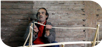
Imagen X Construcción entramado asiento, Elaboración propia.
