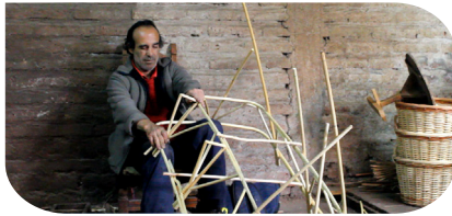
Imagen X Proceso constructivo curvado varas frontales; Elaboración propia.
