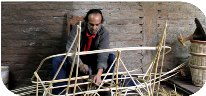
Imagen X Construcción entramado asiento, Elaboración propia.
