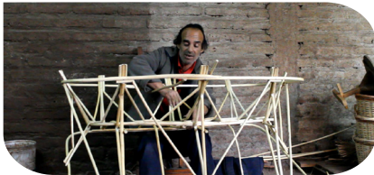
Imagen X Construcción varas centrales inferiores, Elaboración propia.
