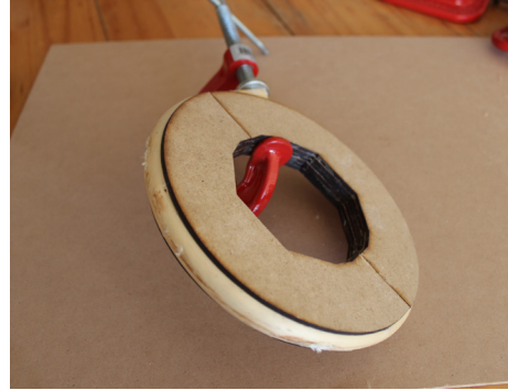
defectos superficiales resultantes del uso de las prensas
