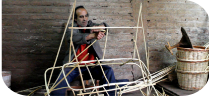
Imagen X Construcción refuerzos respaldo, Elaboración propia.
