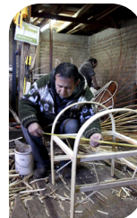
Imagen X Proceso ensamblaje laterales, Elaboración propia.
