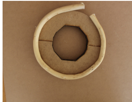
resultado mimbre luego de retirar del molde, se debe ejercer fuerza para poder retirar la vara de la matriz, ya que esta es conformada por una sola pieza, lo que propicia su deformación.
