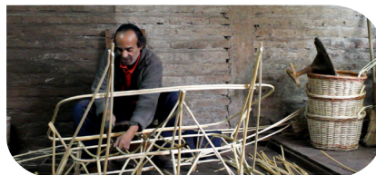
Imagen X Construcción entramado asiento, Elaboración propia.
