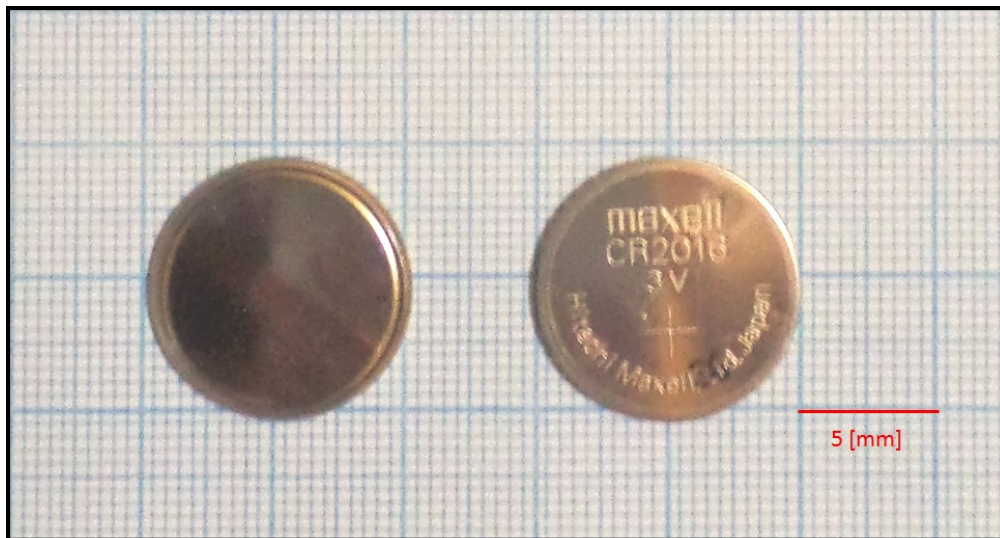
Figura 4.2: Batería de botón utilizada en los robots modulares.
