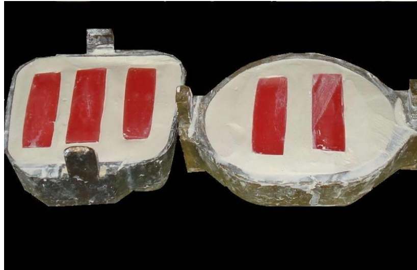
Fig. 4: Muflas con yeso piedra y patrones de silicona.
