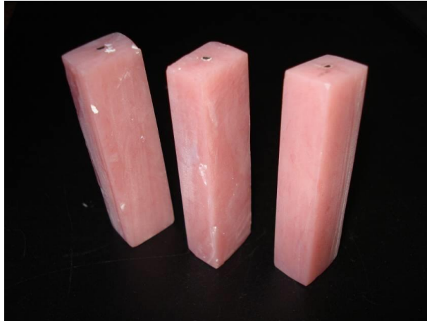
Fig. 6: Probetas con alambre terminadas
