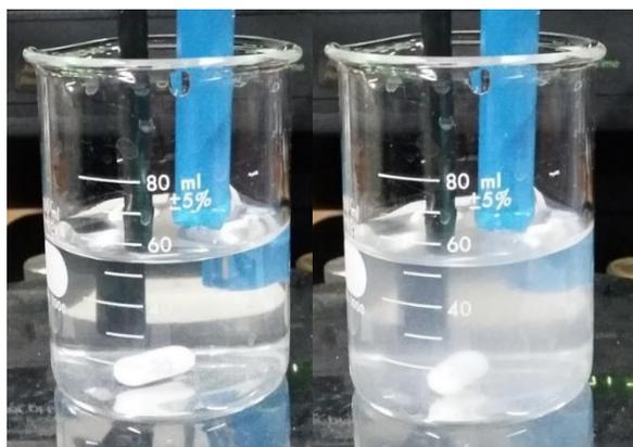
Figura 27: Comparación solución con y sin precipitado (a la izquierda solución sin precipitado -pH 4,04-, a la derecha solución con indicios de precipitación -pH 4,1-).
