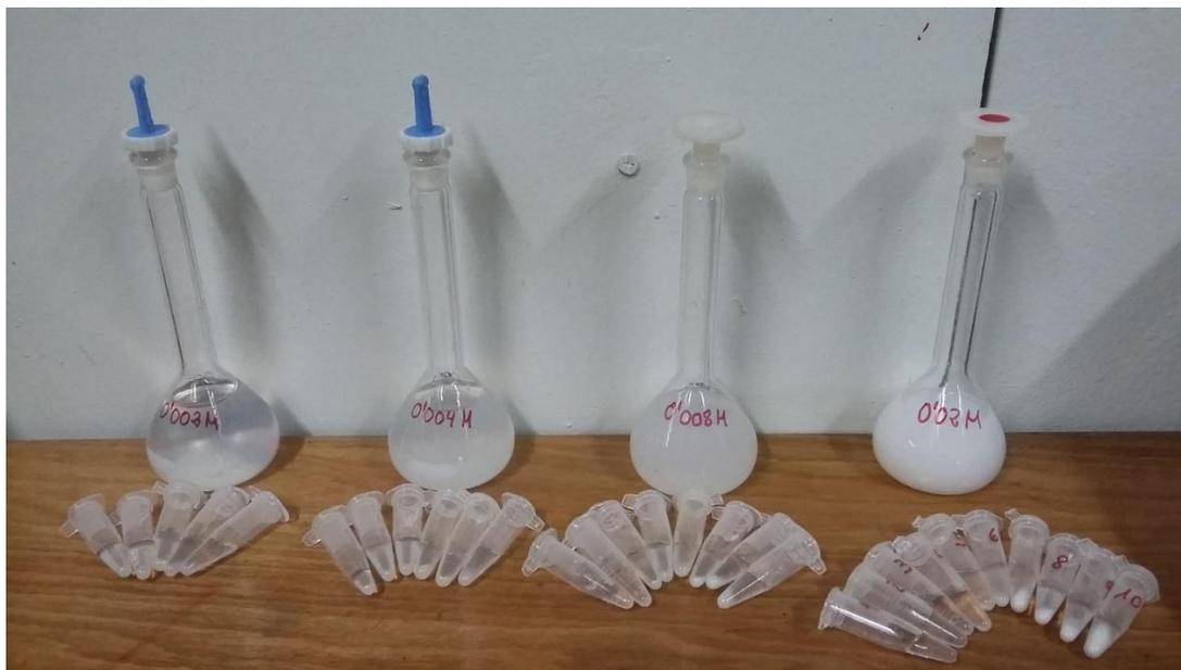
Figura 7: Las cuatro soluciones ocupadas en este trabajo con sus respectivas muestras. Las soluciones se encuentran en su estado final, es decir, en el valor máximo de pH alcanzado una vez terminada la precipitación de hidrobasaluminita.
