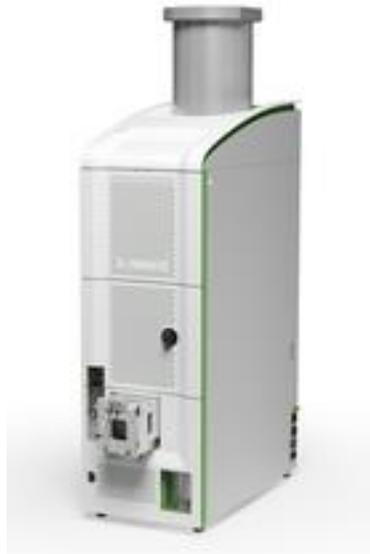
Figura 5: Espectrómetro de masas ESI-TOF (imagen referencial).
