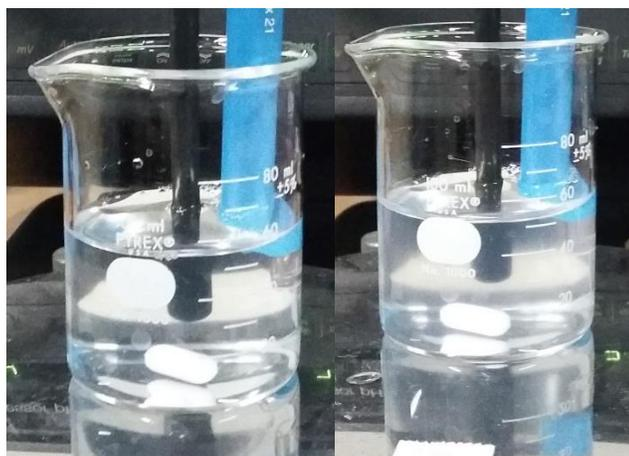
Figura 9: Comparación solución con y sin precipitado (a la izquierda solución sin precipitado -pH 4,28-, a la derecha solución con indicios de precipitación -pH 4,31-).
