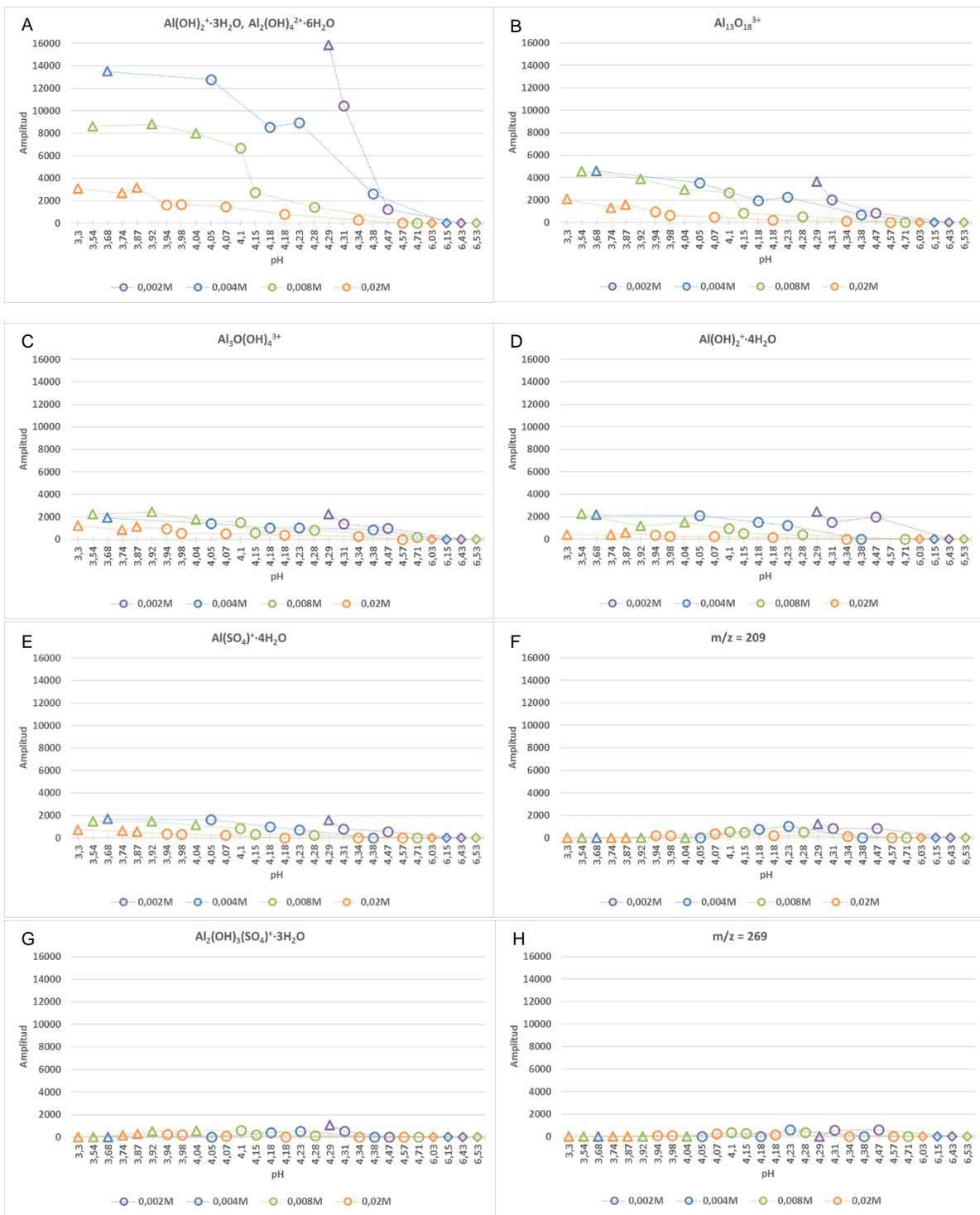
Figura 56: Especies que tienden a desaparecer junto con el aumento de pH (Casos F, G y H solo solución 0,002M). Los triángulos representan muestras previas a la precipitación, círculos muestras durante la precipitación y rombos muestras una vez terminada la precipitación.
