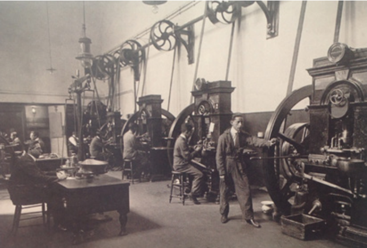
Fig. 100. Taller de la Casa Moneda de Chile 1850, Prensas de acuñación Thonnelier. Fuente: Iconografía de monedas y billetes chilenos. Banco Central de Chile, 2009.
