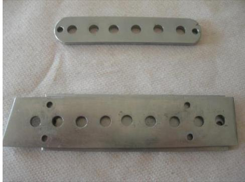
**Fig. 3** Formadores de Probetas Metálicas
