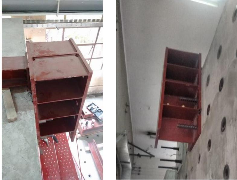
**Figura 6-4 Espaciador anclado al muro de reacción**
