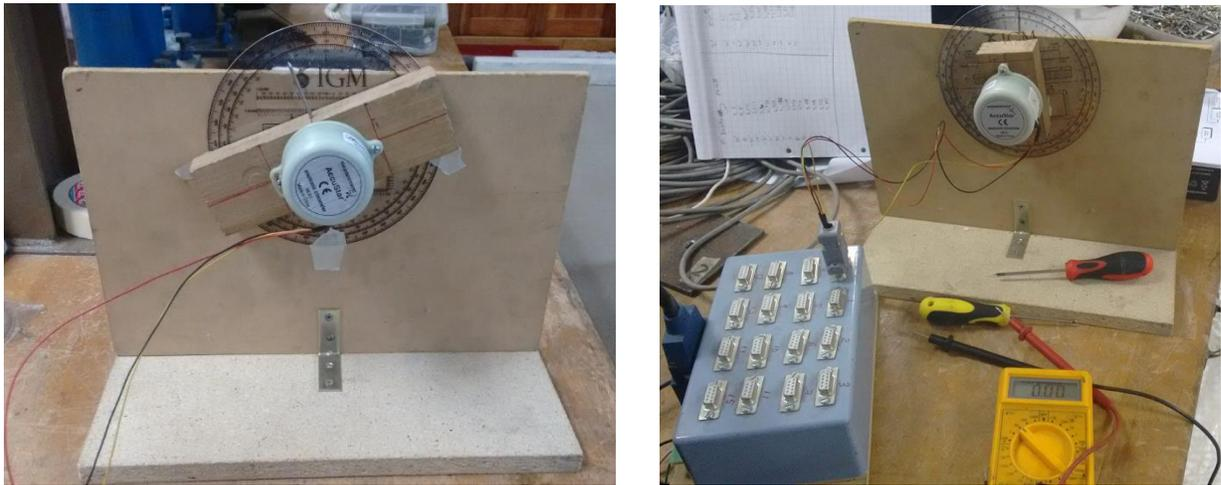
Figura 2-16 Calibración Inclinómetros
