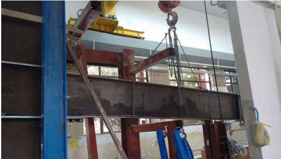
**Figura 6-12 Montaje de la Viga de la Probeta**
