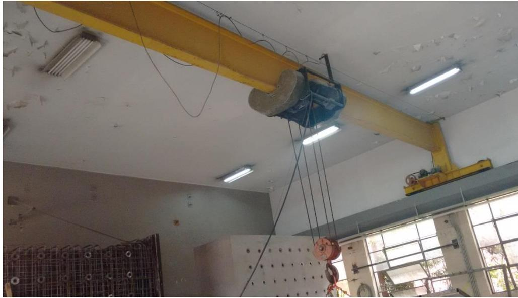
**Figura 2-5 Puente grúa del Laboratorio de Estructuras**
