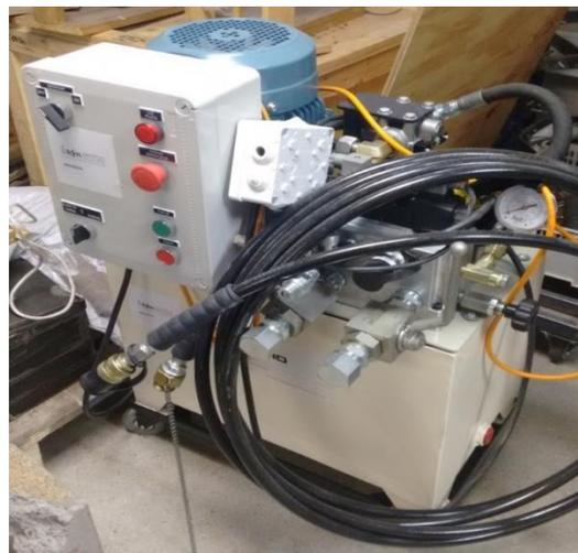
Figura 2-20 Bomba del actuador hidráulico
