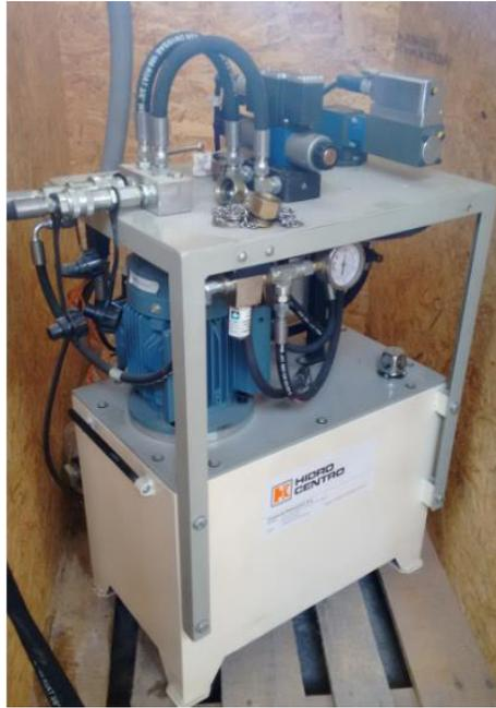
Figura 2-8 Bomba de aceite gatos hidráulicos
