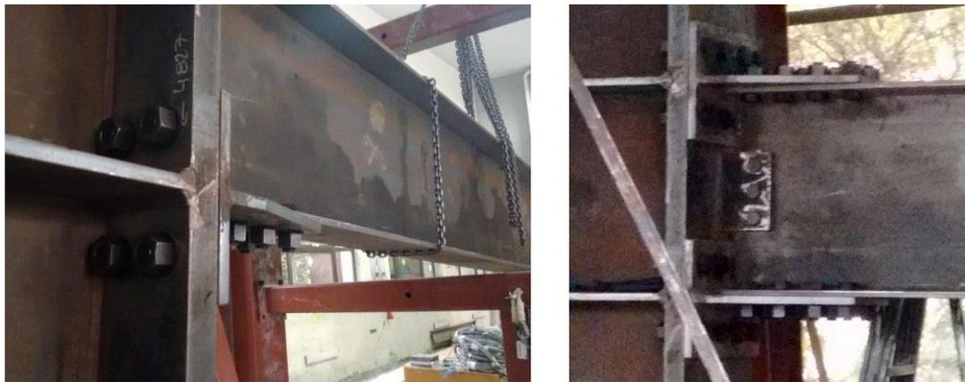
**Figura 6-13 Posicionamiento de Conexiones Superiores y Llave de Corte**
