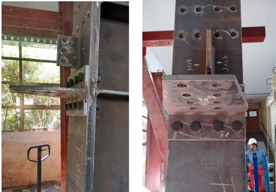
**Figura 6-11 Posicionamiento de Conexión Viga-Columna**
