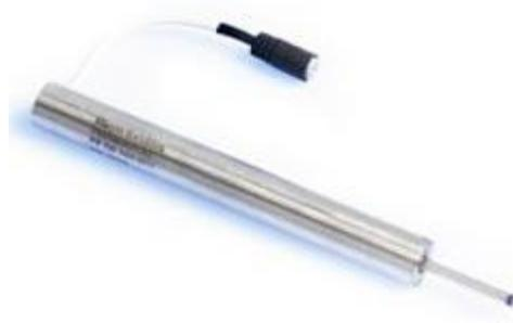
**Figura 2-9 LVDT de la instalación experimental**
