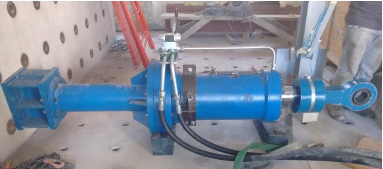
**Figura 2-6 Actuador Hidráulico**
