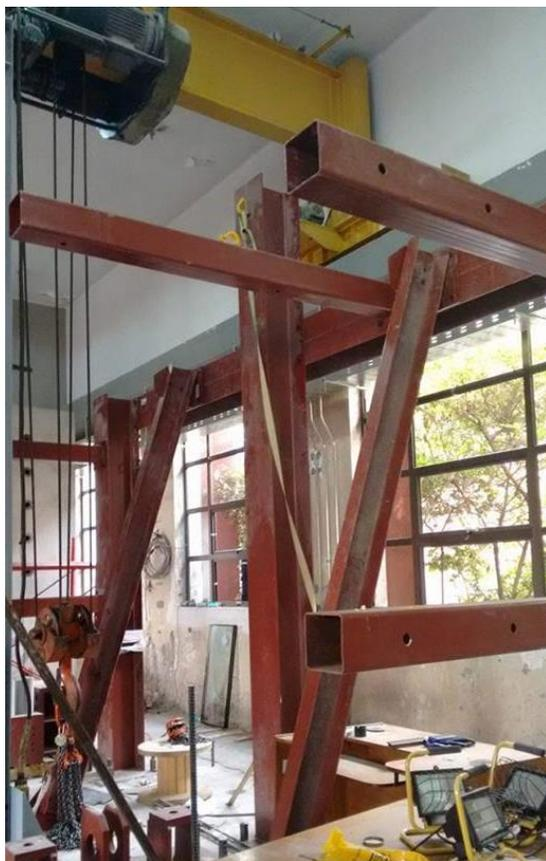
**Figura 6-7 Perfiles Canal (puntales diagonales)**
