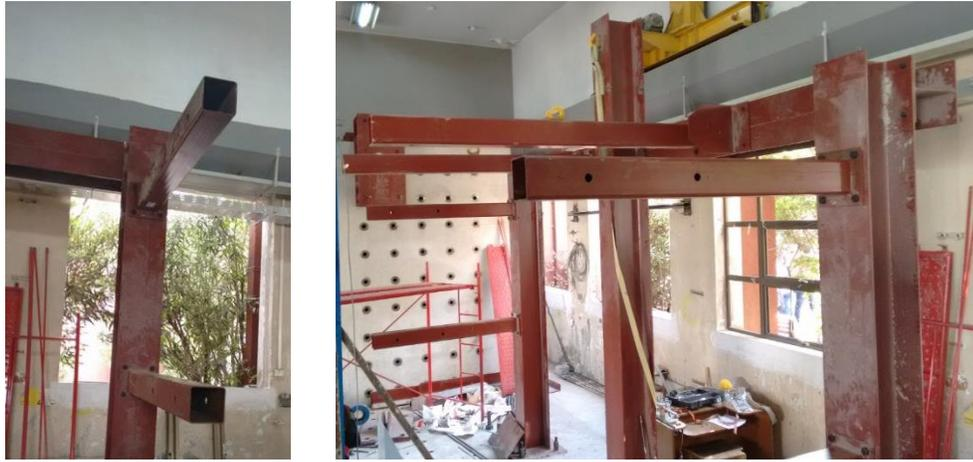
**Figura 6-6 Montaje de perfiles cajón del marco de restricción fuera del plano**
