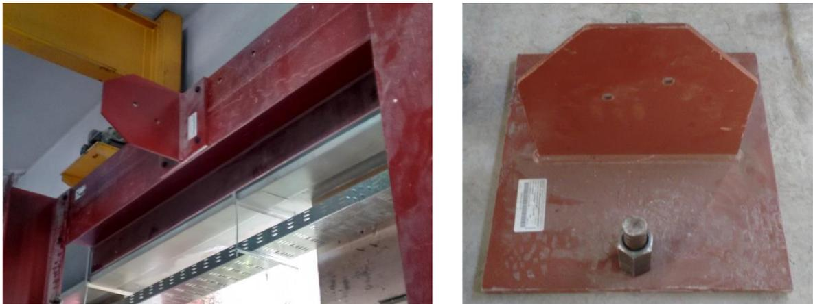
**Figura 6-5 Gussets de la instalación experimental**
