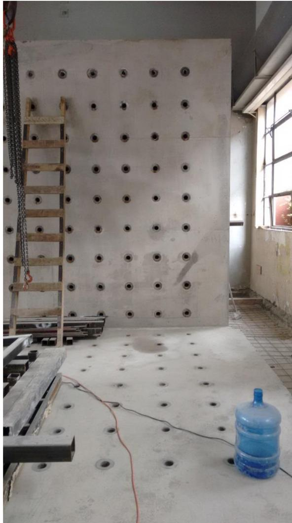
**Figura 2-4 Muro y Losa de Reacción del Laboratorio de Estructuras**
