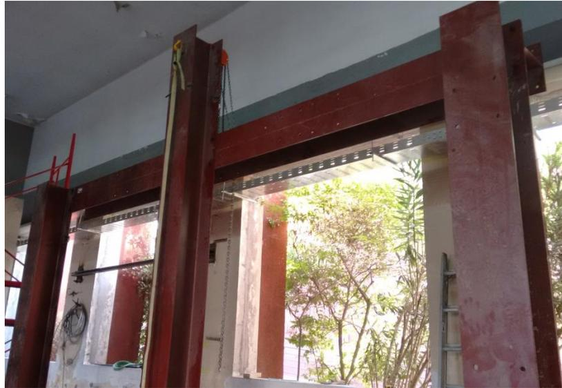
**Figura 6-2 Viga del marco de restricción lateral**
