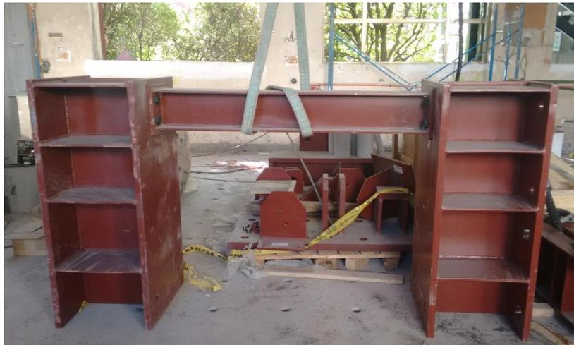
**Figura 6-3 Espaciador conexión Actuador-Columna**
