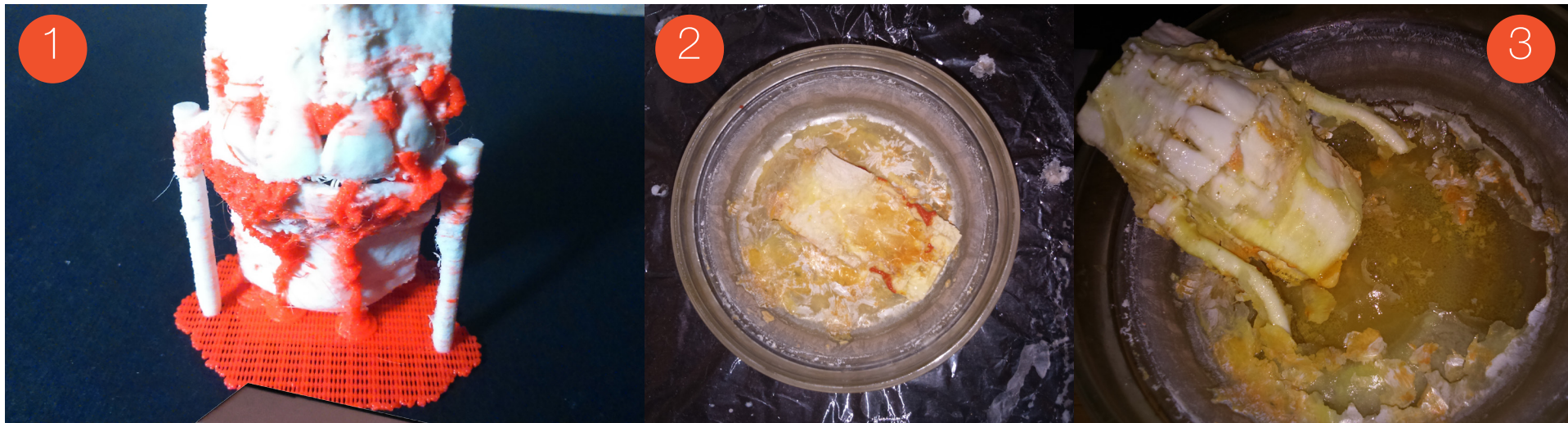
Fig. 93: Proceso de experimentación con solución de soda cáustica. PRECAUCIONES: Uso obligatorio de mascarilla, antiparras, guantes y transcurso de la experimentación en un ambiente ventilado.
