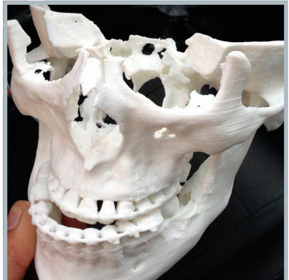
Fig. 12: Fotografía de un biomodelo físico, fabricado mediante modelado por deposición de fundente Fuente: http://studio3d.med.ec/web/assets/img/casos/biomodelos4.jpg
