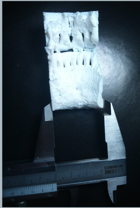
Fig. 84: Arriba: Fotografías del proceso de medición en el biomodelo físico del prototipo 3, se seleccionaron puntos en las esquinas formadas por los planos de corte en el lado derecho, debido a la falta de puntos de medición anatómicos relevantes. Abajo; Medidas tomadas desde Mimics. Fuente: Elaboración Propia.
