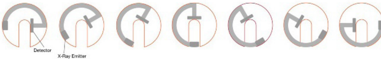
Fig.,19: Funcionamiento de un scanner CT (izquierda) y un scanner CBCT (derecha), abajo se muestra una secuencia de movimiento de exploración de los escáneres, mientras que el scanner CT realiza un movimiento helicoidal, el scanner CBCT sólo necesita una exploración circular. Fuente: http://payload74.cargocollective.com/1/8/261498/3797811/cbct1.jpg
