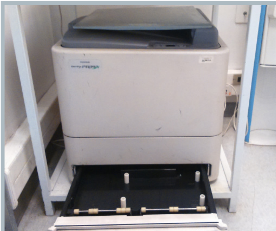
Fig. 6: Arriba, fotografía de la impresora marca Fujifilm, modelo Drypix Prima, con la que se fabrican las radiografías actualmente en FOUCH. Derecha, fotografía de un negatoscopio utilizado para visualizar las láminas de acetato impresas. Fuente: Elaboración propia.
