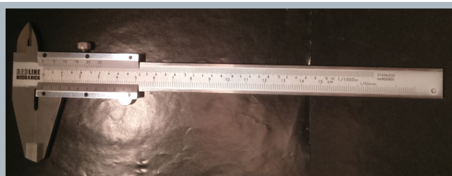
Fig. 82: Pie de metro utilizado para medir las dimensiones de los prototipos físicos. Fuente: Elaboración Propia.
