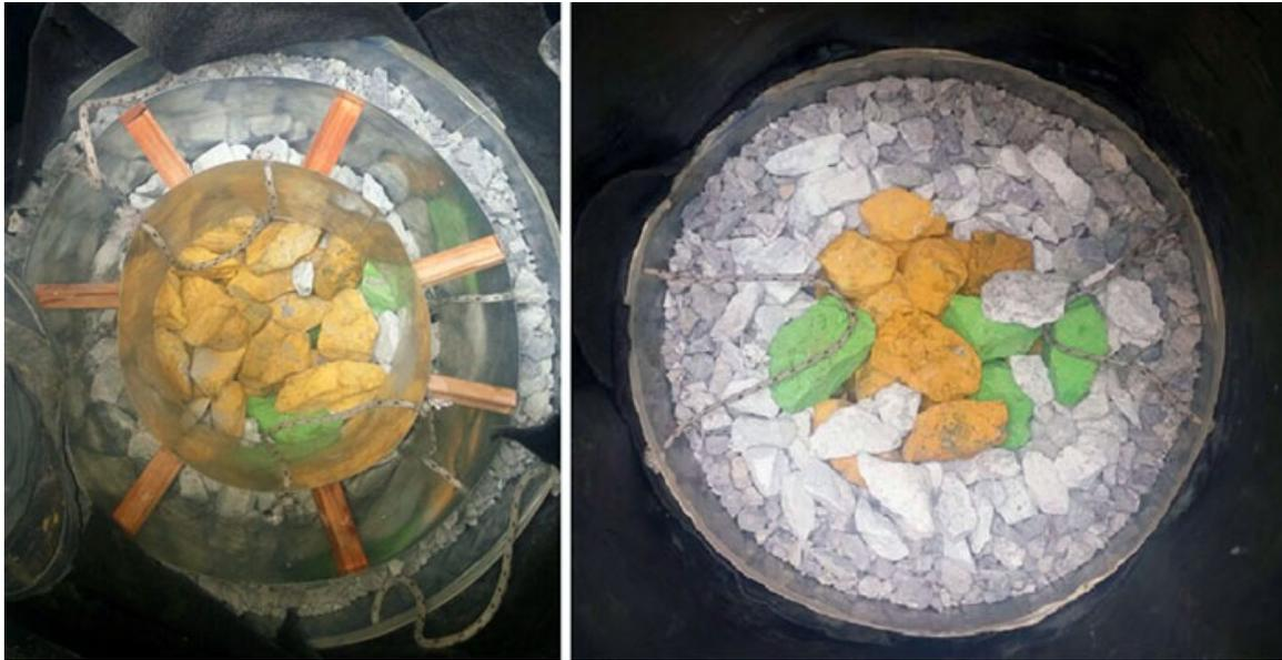
Figura 37: colocación del material para una capa PES
