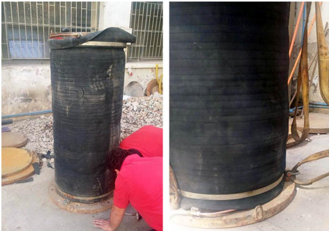
**Figura 31: probeta armada con la capa protectora, se observa una reducción importante de la deformación de la geomembrana.**
