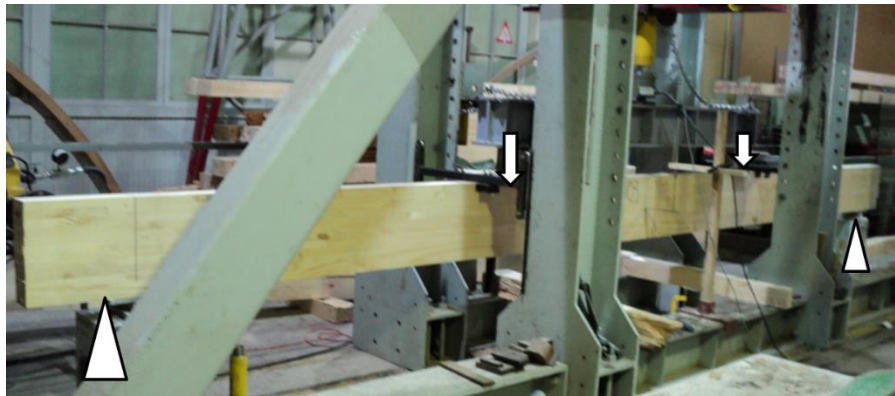
Figura 5-5: Viga de MLE (Pino radiata) durante ensayo a flexión.
