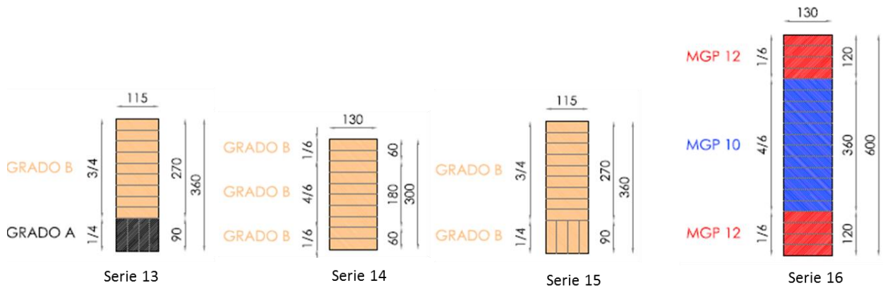
Figura 5-2: Cortes transversales de vigas a ensayar. Laminación vertical en cuarto inferior.
