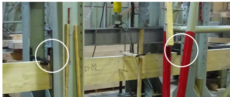
Figura 5-6: Ampliación vista ensayo, puntos de carga.
