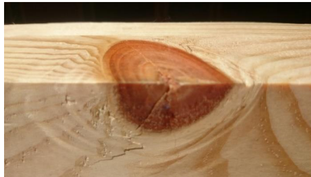
Figura 2-8: Nudo e inclinación de la fibra.
