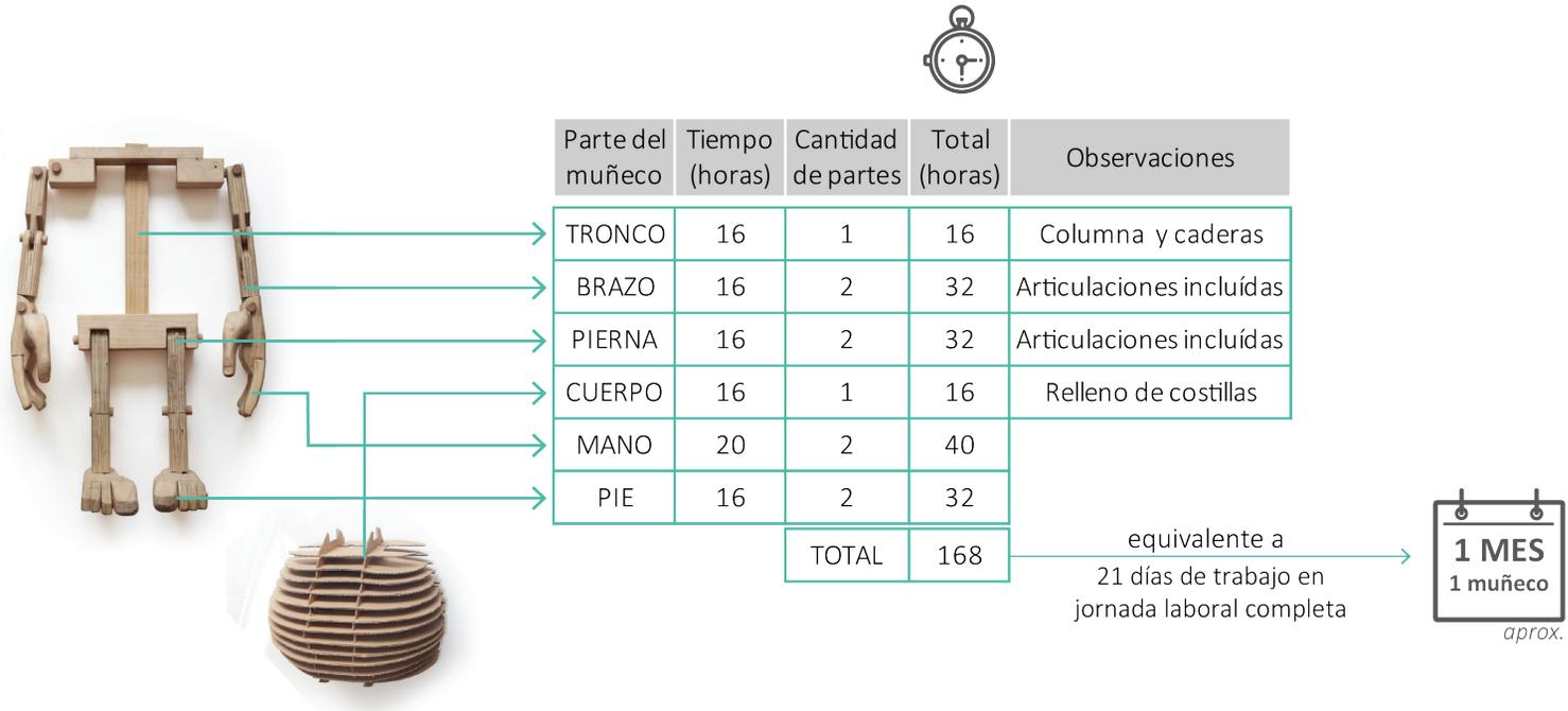
Esquema 07: Tiempos de diseño y fabricación (Elaboración propia, 2015)
