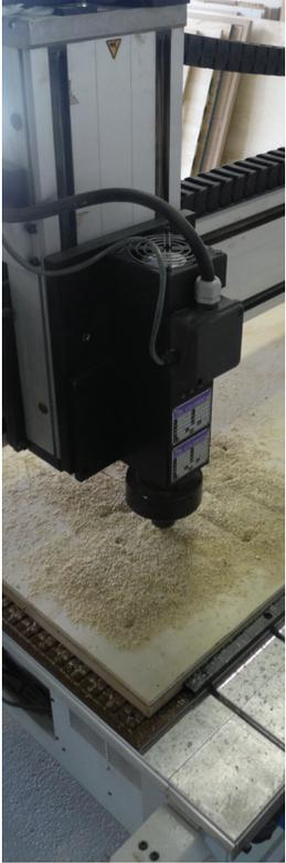
Fabricación de placas individuales de terciado por sistema router CNC
