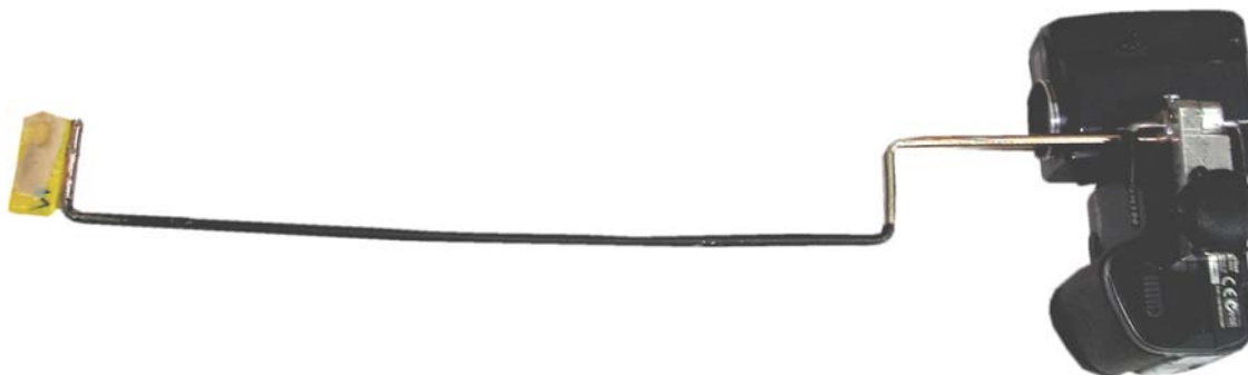
Figura 35. Posicionador y asa para fotografía estandarizada
