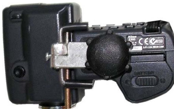
Figura 40. Pieza de acople atornillada a la base de la cámara fotográfica.
