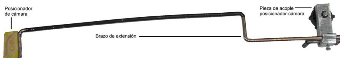
Figura 38. Dispositivo con todas sus partes creado para tomar fotografías estandarizadas.
