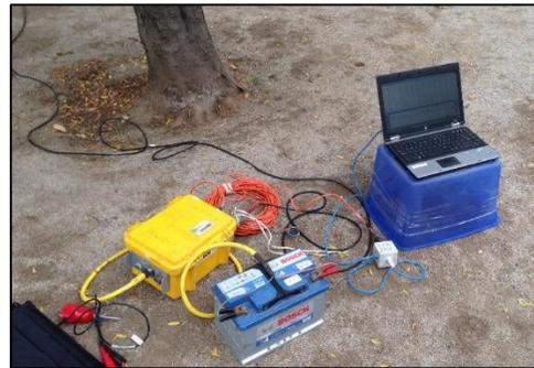
Figura 7.4: Geode, Laptop y Batería en terreno.
