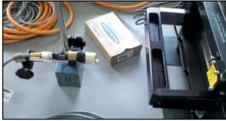
Figura 4.1: Ultrasonico midiendo el desplazamiento del Vibrador horizontal
