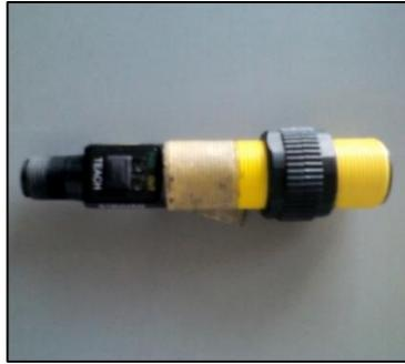
*Figura 2.15: Sensor de desplazamiento o Ultrasónico (Banner 2013).*
