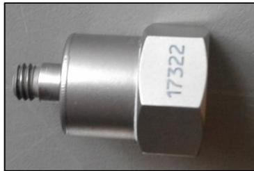
*Figura 2.16: Acelerómetro Serie 17322, ubicado en el laboratorio MECESUP.*
