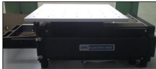
Figura 2.4: Vibrador APS 400 horizontal como mesa vibratoria, con tabla auxiliar incorporada.
