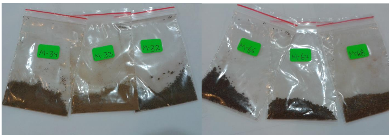
Figura 44. Muestras sometidas a ensayo de adsorción de nitrógeno para determinación de Superficie Específica.
