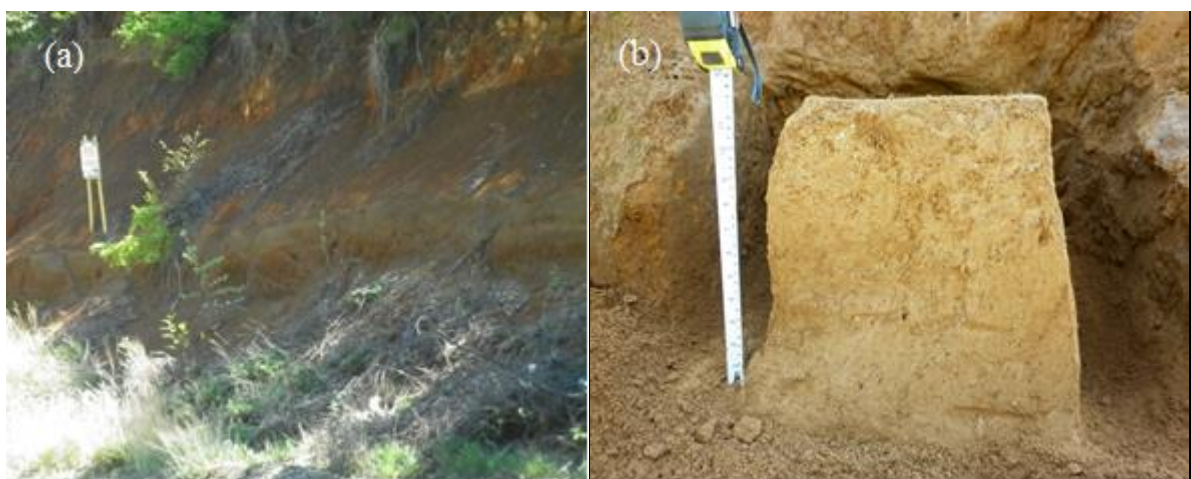
Figura 41. Talud de extracción de muestras (a) y bloque de muestra (b).
