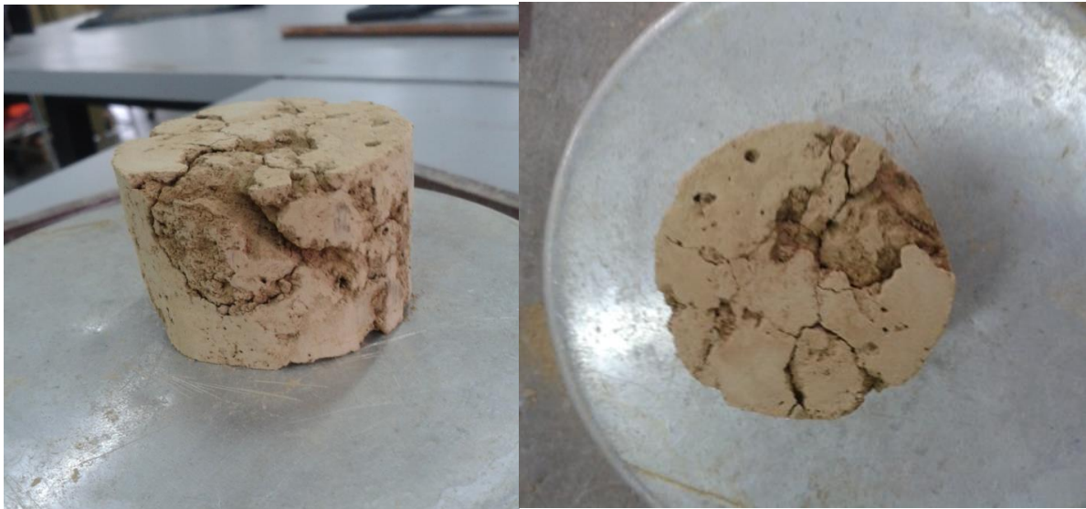
Figura 56. Muestra de Temuco seca y tallada para la realización del ensayo de consolidación.
