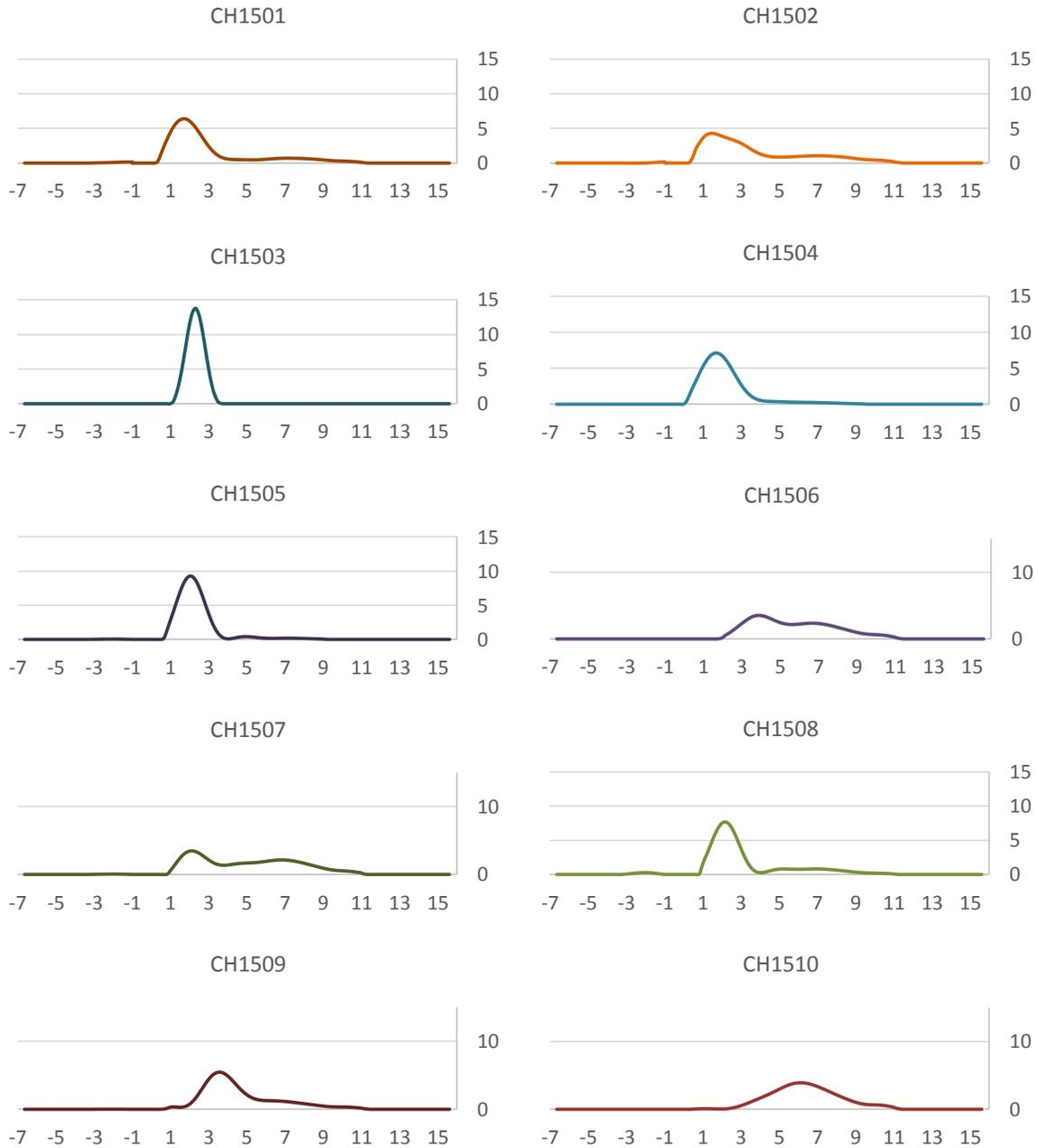
Figura 99. Curvas granulométricas absolutas de las muestras CH1501 a CH1510. Eje vertical corresponde a porcentaje en peso y horizontal a tamaño de grano en escala phi.
