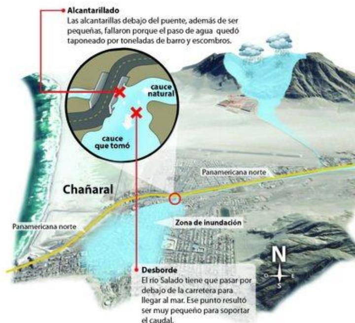
**Figura 97. Esquema infográfico que explica el supuesto motivo de desborde al sur del aluvión de Chañaral, donde se menciona un puente por donde el flujo no podría haber pasado, lo que habría generado el colapso hacia el sur. Extraído de LUN.com, 2015.**
