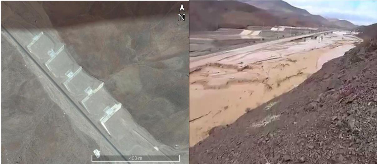
Figura 95. A la izquierda, piscinas de decantación en la quebrada de Taltal, antes de llegar a la desembocadura en la ciudad. A la derecha, captura de video que muestra el aluvión desplazándose al suroeste de las piscinas de decantación. Imágenes extraídas de Google Earth (2013) y Youtube (2015), respectivamente.
