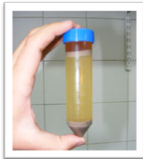
Figura 16. Diferentes fases obtenidas luego de la centrifugación, de arriba abajo: aceite, emulsión, fase soluble y fase insoluble.
