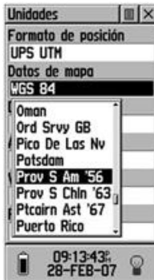
La razón de esta discrepancia está en la transformación de coordenadas y no en la medida misma. El GPS internamente para cambiar de un datum a otro tiene parámetros de transformación nominales, válidos para toda Sudamérica, esto es la fuente del error, ya que la precisión de estas transformaciones es baja y fácilmente puede sobrepasar los 50[m] de error.
