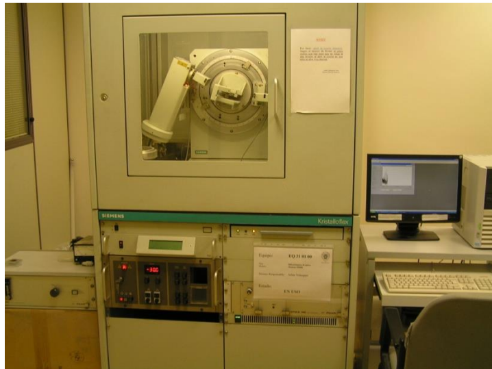
Figura 1. Difractómetro de rayos X de polvo modelo Siemens D 5000
