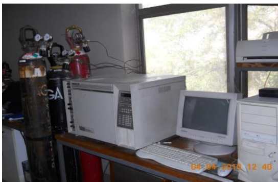
Figura 3. Cromatógrafo de gases marca Hewlett Packard modelo 5890 SERIES II
