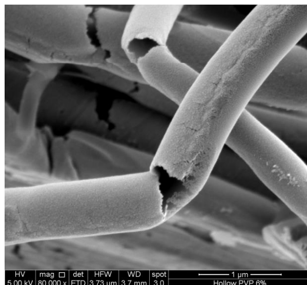
Fig. 11. Imagen SEM de fibra PVP 6% hueca.
