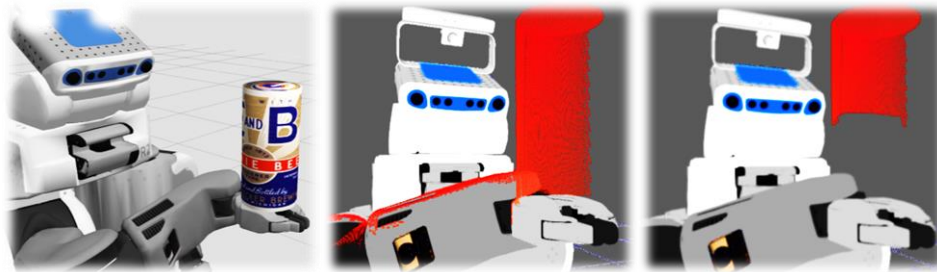
Ilustración 21: Resultado de usar auto-filtro de MoveIt con valores por defecto. A la izquierda, la situación simulada. Al medio, la nube de puntos cruda capturada por el Kinect. A la derecha, la versión auto-filtrada con padding de 10cm.
