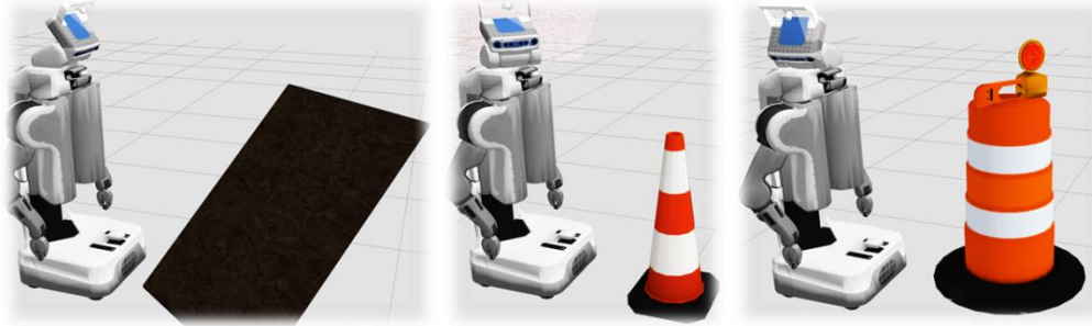
Ilustración 58: Objetos no detectados como superficie. De izquierda a derecha, una rampa en 120°, un cono de construcción y un tambor de señalética.
