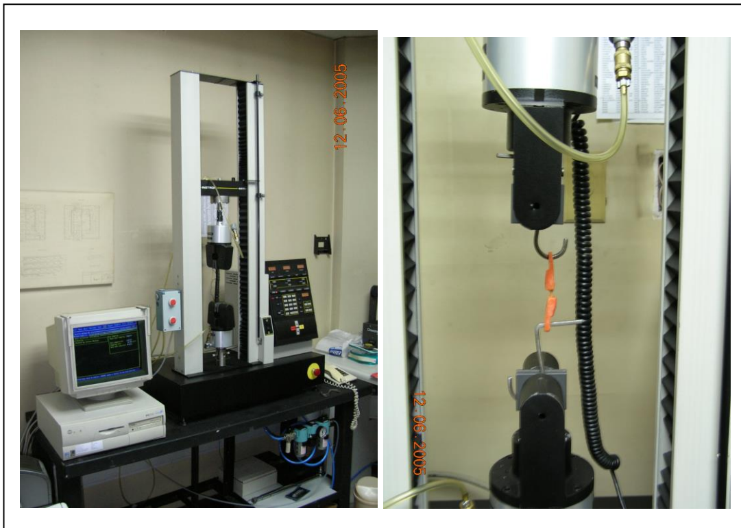
Figura 11 izq. : Máquina Instron visión general. Figura 12 der : Probeta en prueba de tracción.
