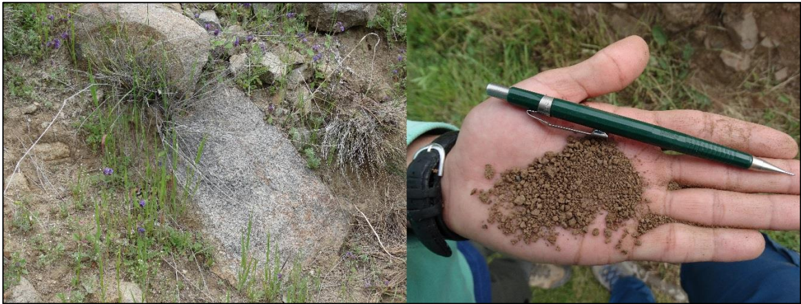
Figura 4.14. Escombros de falda. A la izquierda bloques de 0,5-1 m de diámetro, a la derecha matriz limo-arenosa.
