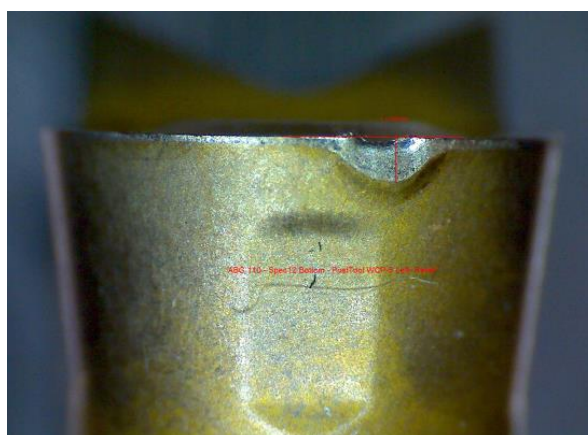
Figura 4.12: Imagen de falla de herramienta WCP-5
