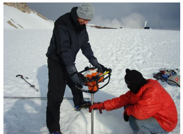
Imagen 77: Perforación en hielo con taladro para insertar barras de anclaje. (Fuente: geociencias.unam.mx)
