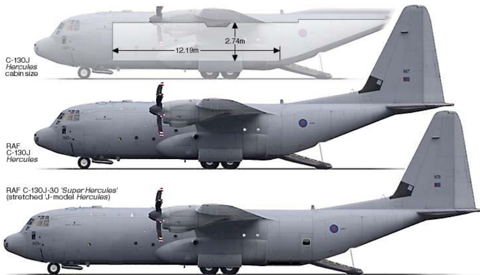
Imagen 88: Esquema de dimensiones en alzado interiores de cabina de carga del Hércules C-130. (Fuente: fierasdelaingenieria.com)
