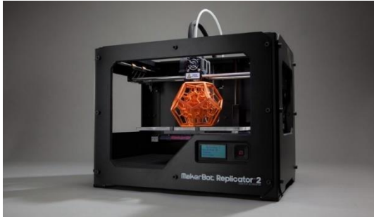
Imagen 1: Impresora 3D que utiliza la tecnología aditiva para realizar un prototipo material de un diseño virtual. (Fuente: 20minutos.es)
