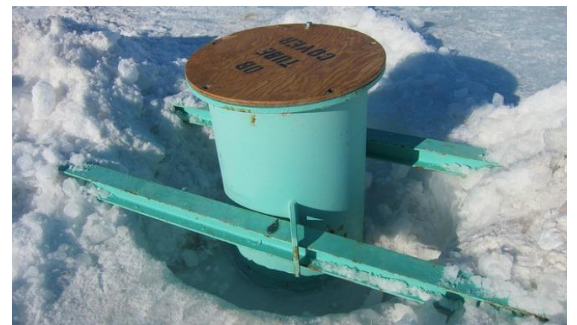
Imagen 6: Boca de sondeo y registro de estratos de hielo. (Fuente: bloglemu.blogspot.com)
