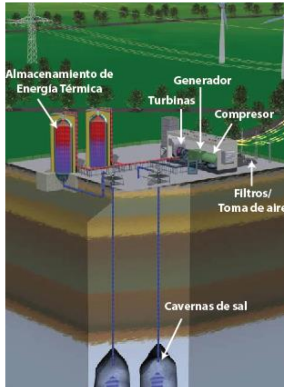
Figura 9: Esquema ilustrativo Planta ADELE, modificado de RWE, 2012
