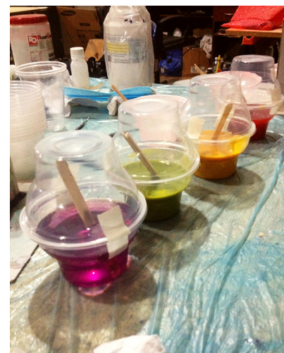
Imágen 61. / Aplicación de color a la Resina Poliéster /
