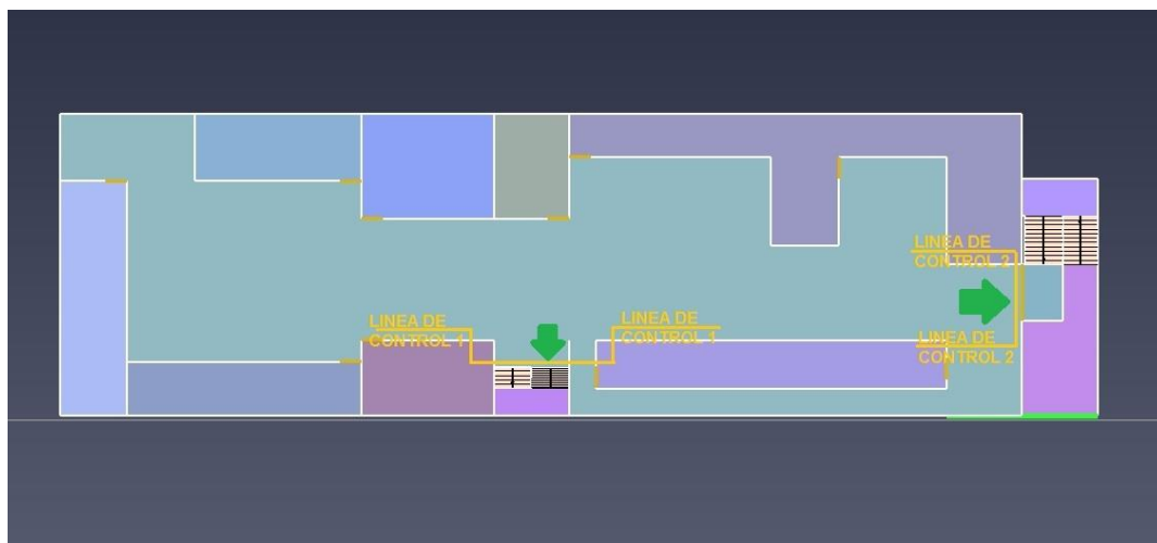
Ilustración 4.7.23.: “Líneas de control en los arranques de las escalera del segundo piso del recinto 2.”
