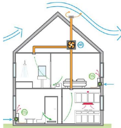
Figura 5.3.6.: “Sistema de extracción de aire tipo D descentralizado Fuente: Múltiples soluciones de admisión y extracción de aire; Jerry Vinkesteyn.”
