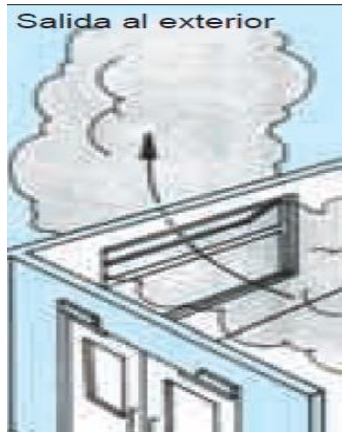
Figura 5.3.4.: “Ventanales amplios con aberturas superiores abiertas de manera permanente.” [23]
