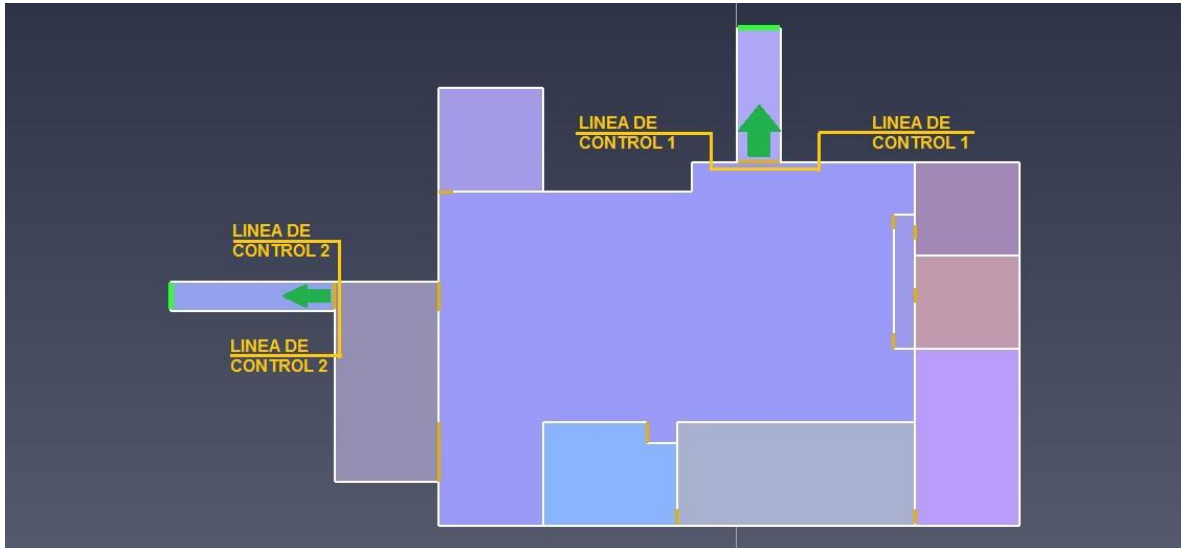
Ilustración 4.7.40.: “Líneas de control en los arranques de los pasillos de evacuación de la discoteca 3.”
