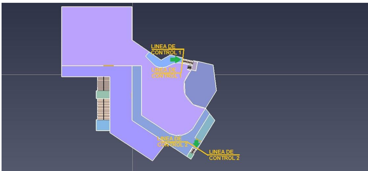
Ilustración 4.7.6.: “Líneas de control en los arranques del segundo piso de las escaleras de la discoteca 1.”
