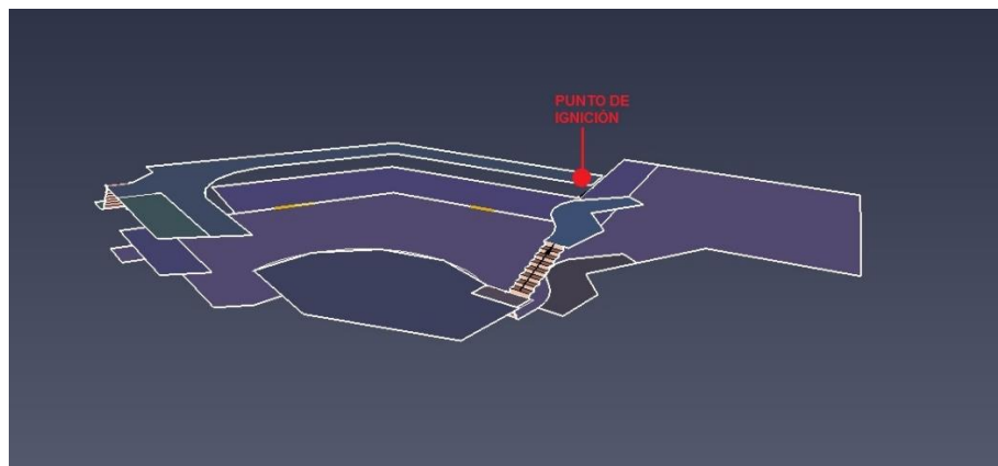
Ilustración 4.7.17.: “Vista superior del punto de ignición del escenario 1A ubicado en el vip 2 del segundo piso del recinto 1.”
