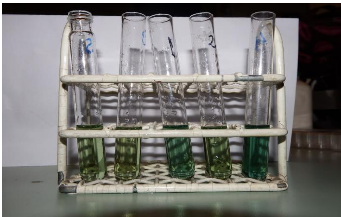
Fig.4: Tubos de ensayo con muestras de saliva más 2 mL del reactivo de antrona, con desarrollo de color para la medición espectrofotométrica.
