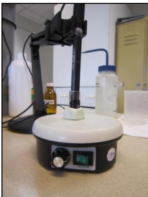
Fig.3: Medición de pH para determinar la capacidad buffer.
