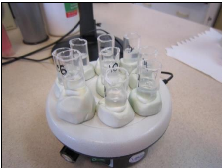
Fig.2: Muestras de saliva con HCl 0,005M en agitación.
