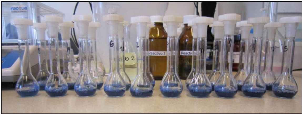
Fig.7: Matraces con 0,1 ml de saliva, 1,0 ml de reactivo R1 y 0,2 ml de Reactivo R2 y R3, con desarrollo de color para la determinación de fosfato.
