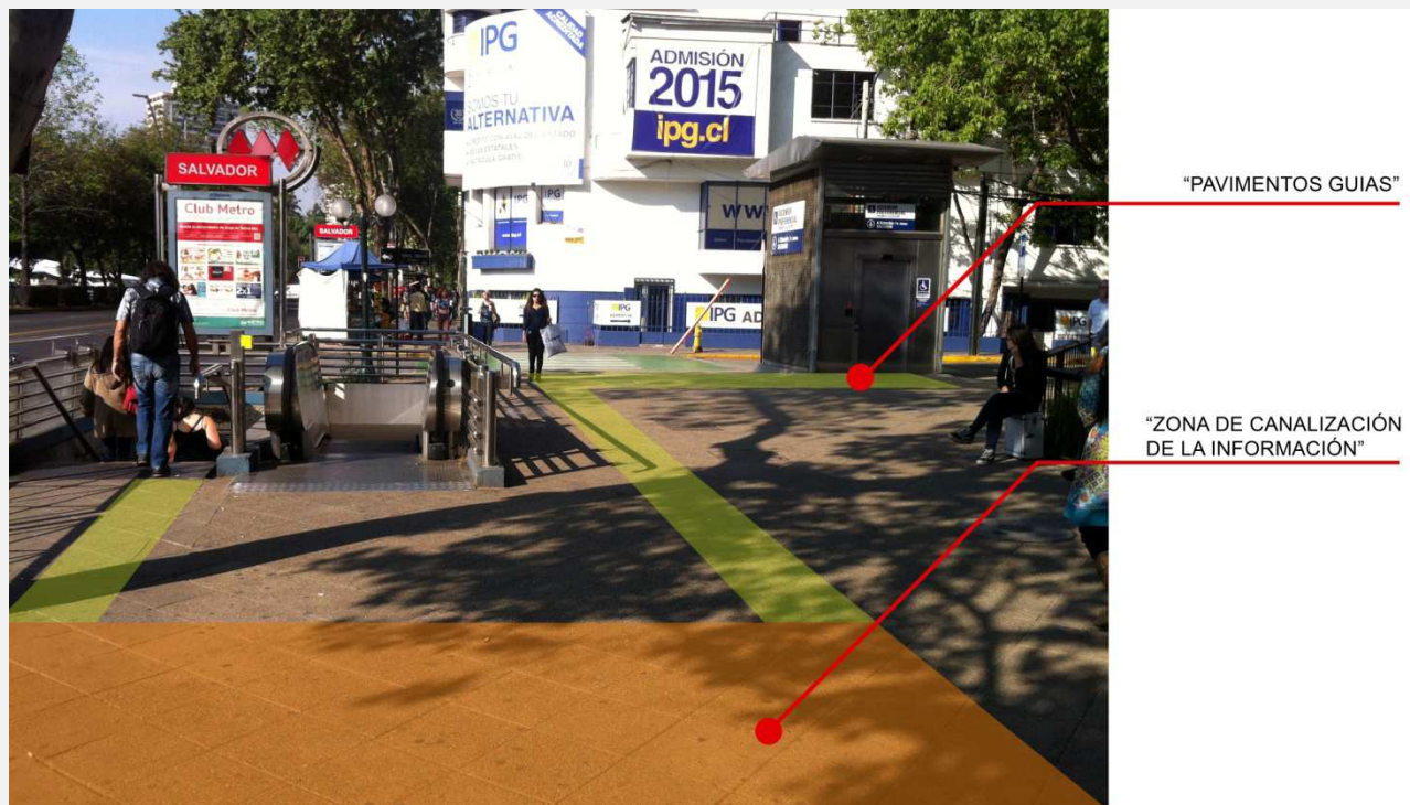
Figura 75: Propuesta de pavimentos guías en el exterior de la Estación de Metro Salvador.
