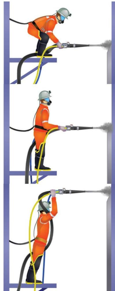
Imagen 149 – Esquemas de aplicación de hormigón proyectado de forma manual, aplicable al proyecto. Fuente: Guía Chilena del Hormigón Proyectado.
