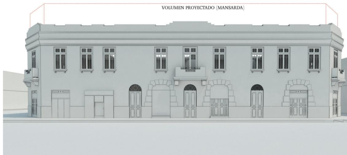
Fig. 6.15. Criterio de altura, volumetría máxima propuesta para una 'casa de alto de uso mixto'. Fuente: elaboración autores.
