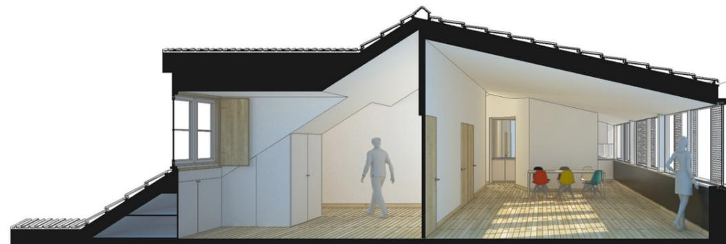
Corte intervención: Se observa que la nueva techumbre no tiene un rol protagónico, sino que el vano de la ventana y las verticales con un diseño simple se integran en la preexistencia.
