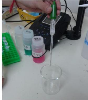
**Figura 4:** Lavado del Electrodo Posterior a La Calibración del pH-metro
