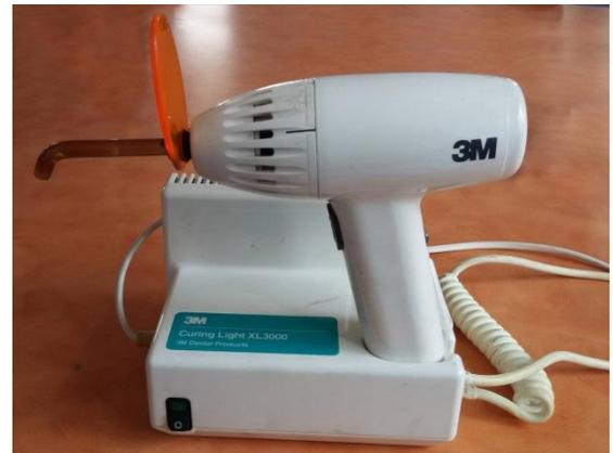
**Fig. Lámpara halógena 3M XL3000**
