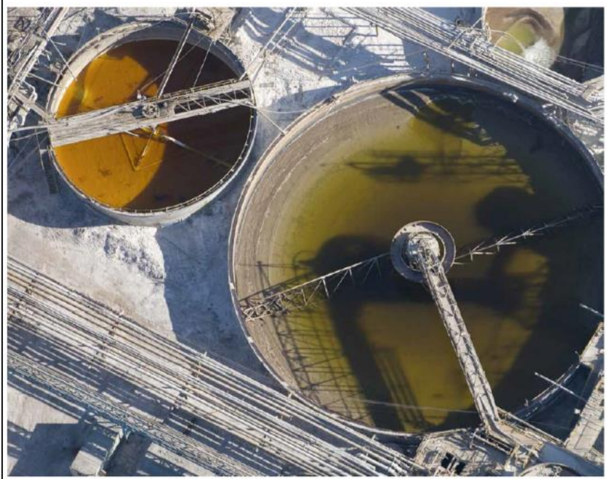
Imagen N°7: Lixiviación en bateas. Fotografía de libro: SQM. María Elena. La magia del último pueblo salitrero en la pampa chilena . 2010
