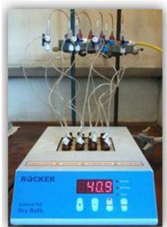
Figura 5-9: Mini Turbo Vap utilizado para secar las muestras con N<sub>2</sub> a 40°C.
