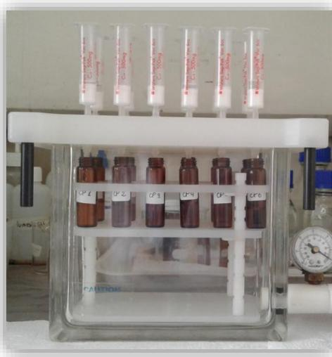
Figura 5-5: Manifold y cartuchos utilizados para el proceso de SPE.
