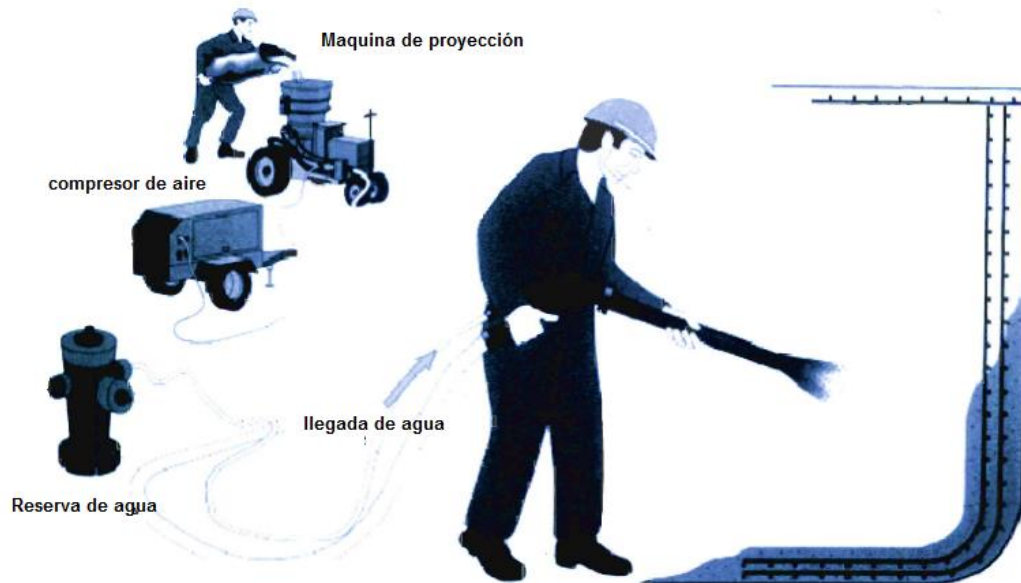
Imagen 2.5: Representación colocación vía húmeda.
