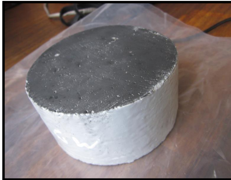
Imagen 5.3: Probeta con grafito es las caras basales de probeta tratada con recubrimiento epóxido en el manto.
