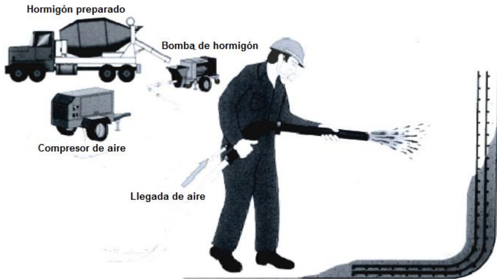
Imagen 2.4: Representación colocación vía seca.
