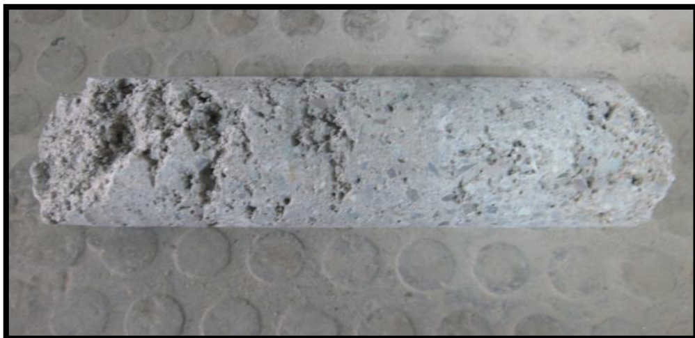
Imagen 3.4: Testigo con oquedades y gran porosidad.
