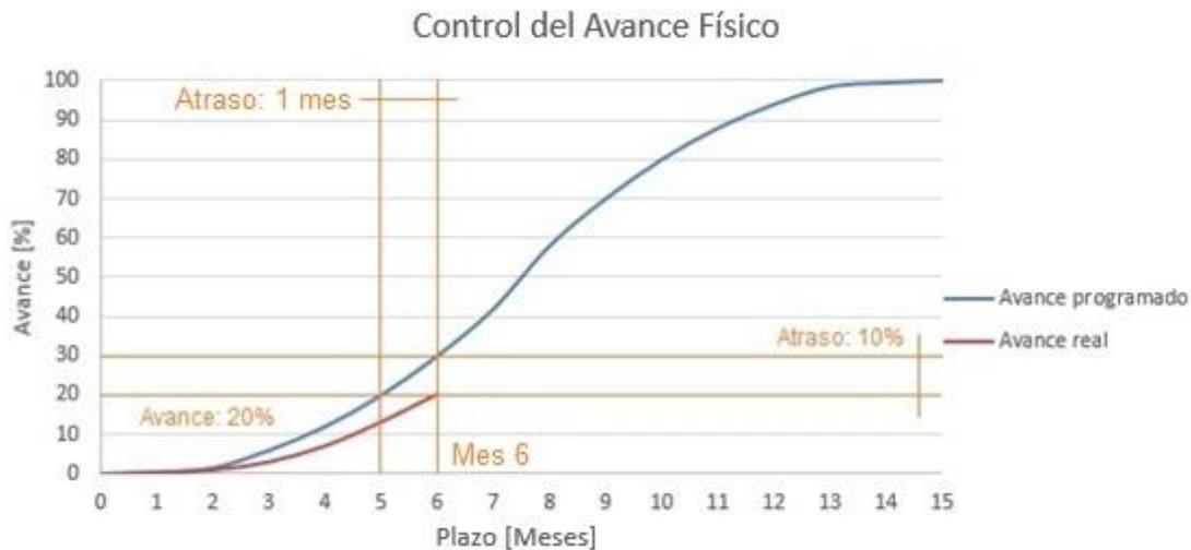
Ilustración 4.7: Ejemplo gráfico curva S del control del avance físico.
