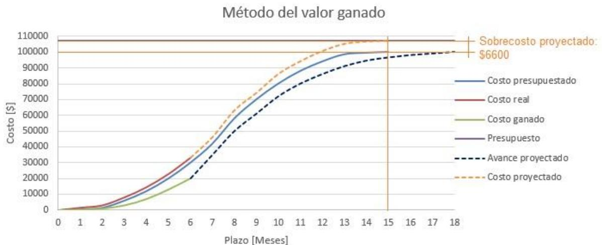
Ilustración 4.11: Ejemplo proyecciones realizadas con el método del valor ganado.
