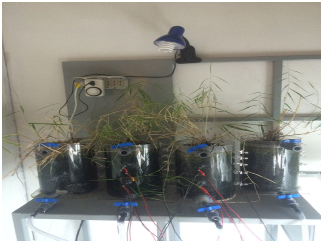
Figura 3.2: Instalación de columnas de humedales con iluminación artificial. Las columnas del centro tienen la MFC funcionando.
