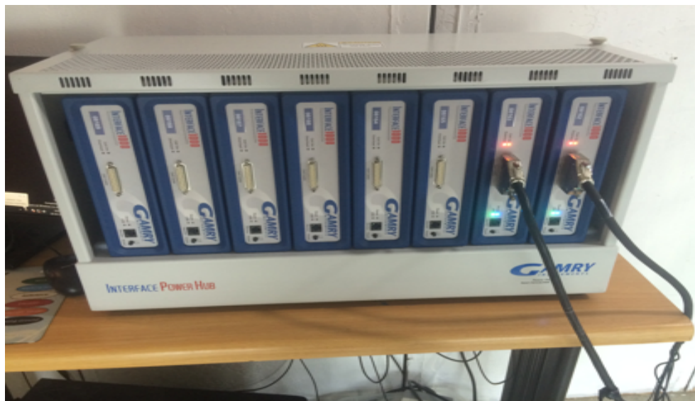
Figura 3.3: Potenciostato usado para funcionamiento de MEC.
