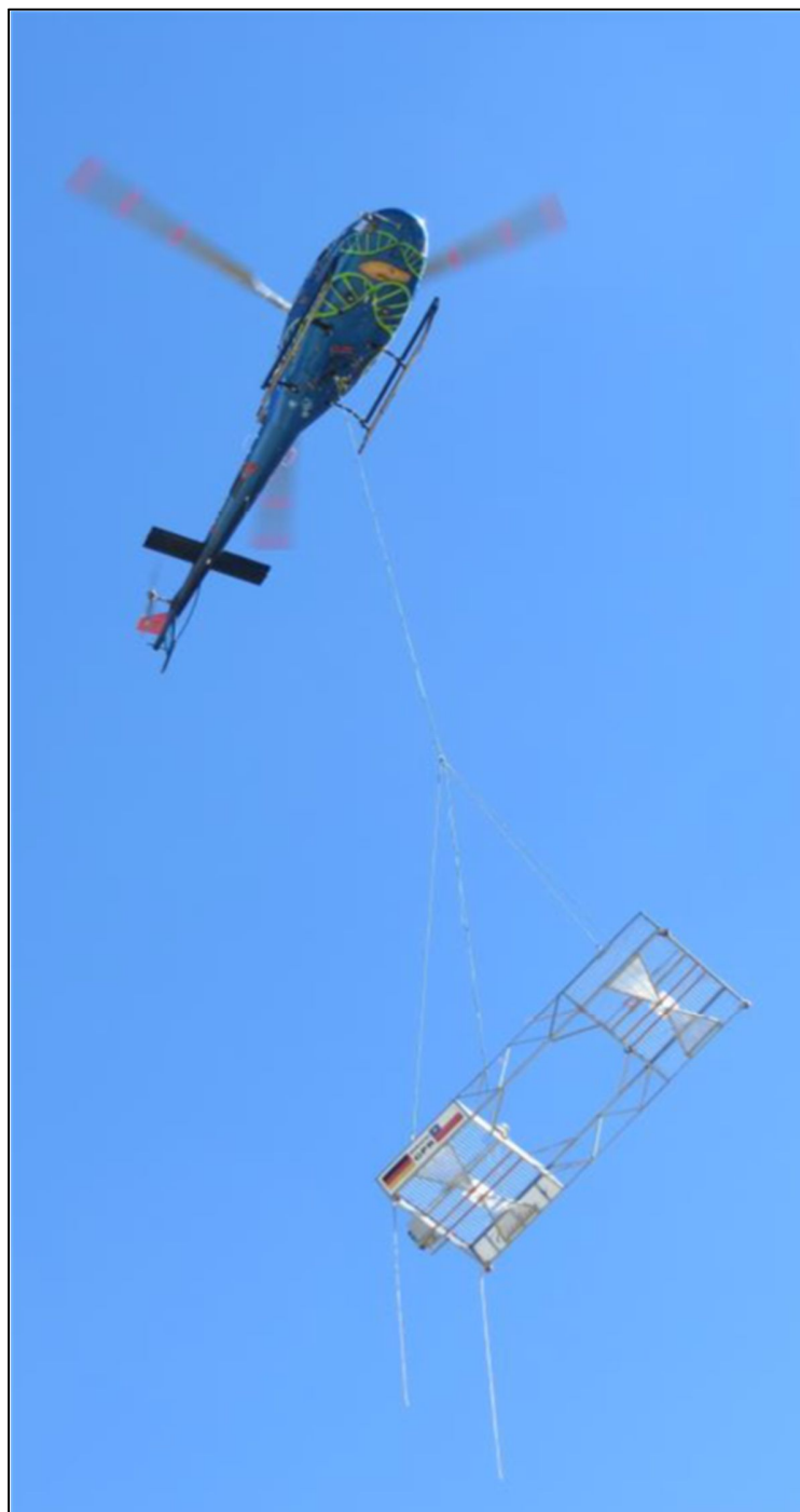
Fig. N°22. Sistema de radar aéreo UMAIR de 50 MHz (Carlina I).
