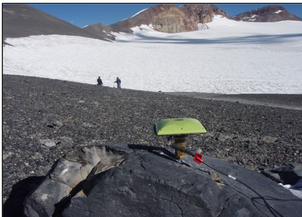
Fig. N°23. Base geodésica instalada en el borde del glaciar del volcán Tupungatito (Foto Gino Casassa).
