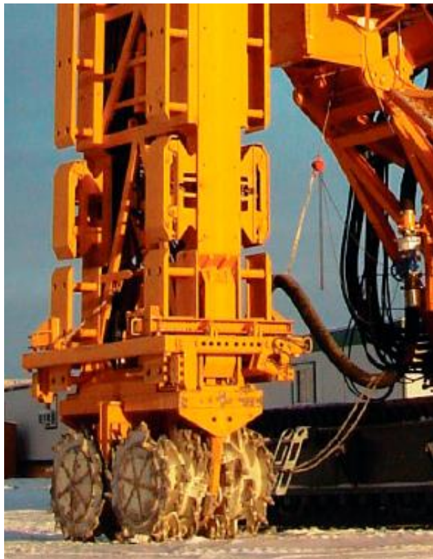
Figura 9: Hidrofresa. Gentileza: http://www.directindustry.es/
