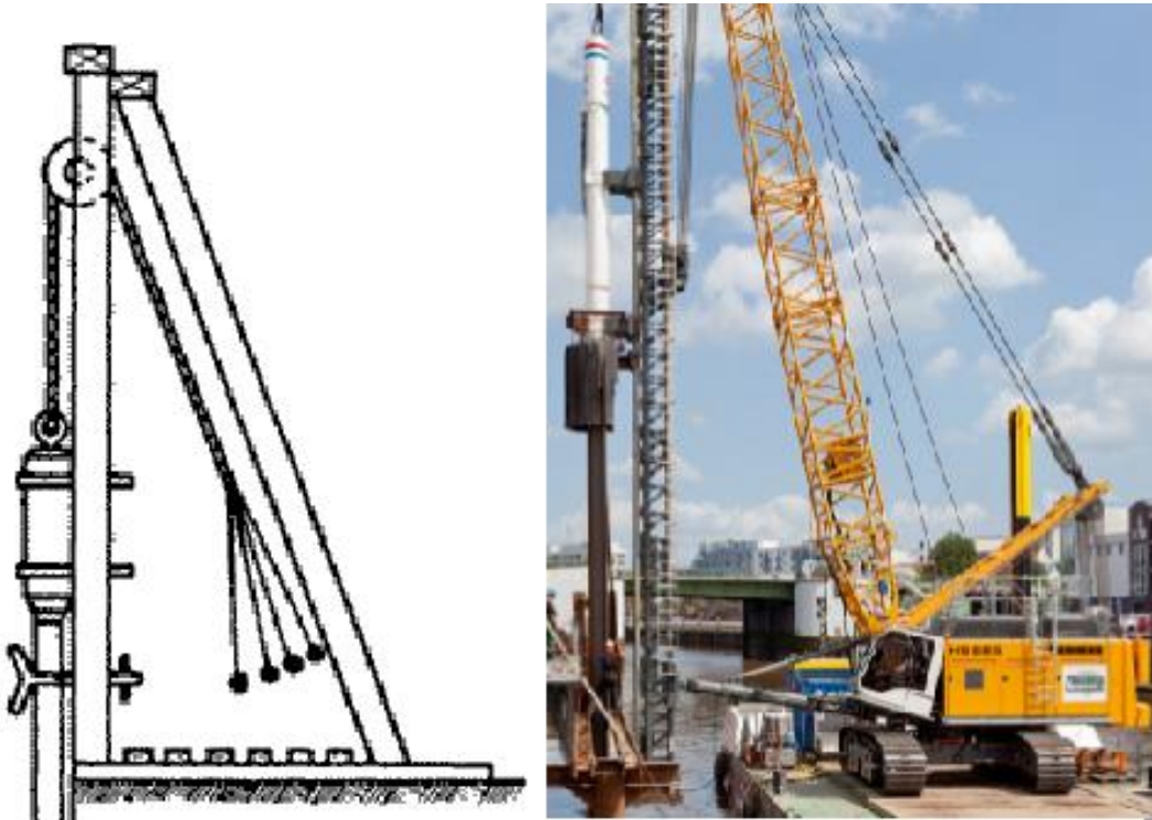
Figura 13: (a) Maza de caída libre impulsada a mano, (b) Maza de caída libre usando cabrestante. Gentileza: (a) http://www.elconstructorcivil.com/search/label/FUNDACIONES?max-results=20 , (b) https://www.liebherr.com/es/bfa/productos/m%C3%A1quinas-de-construcci%C3%B3n/obras-civiles-especiales/tecnicas/hincado/hincado.html
